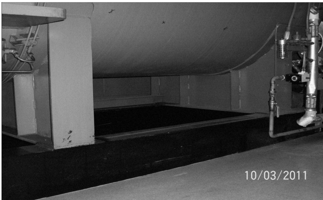
Vue de cote des poutres en I sur lequel l'autoclave est soudé.
