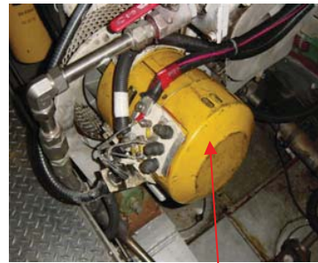
Figure L-01-3 Alternateur bâbord
