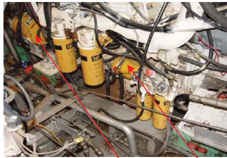
Figure L-01-1 Alternateur et démarreur tribord
