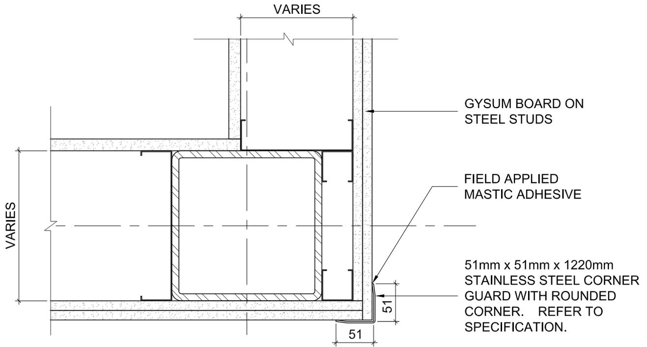
11 TYP. CORNER GUARD AT GYPSUM BOARD WALL DETAIL
