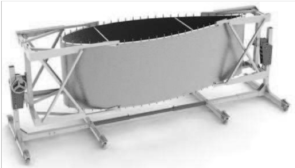
Figure 1 : Exemple d'illustration d'une rôtisserie de dôme sonar
