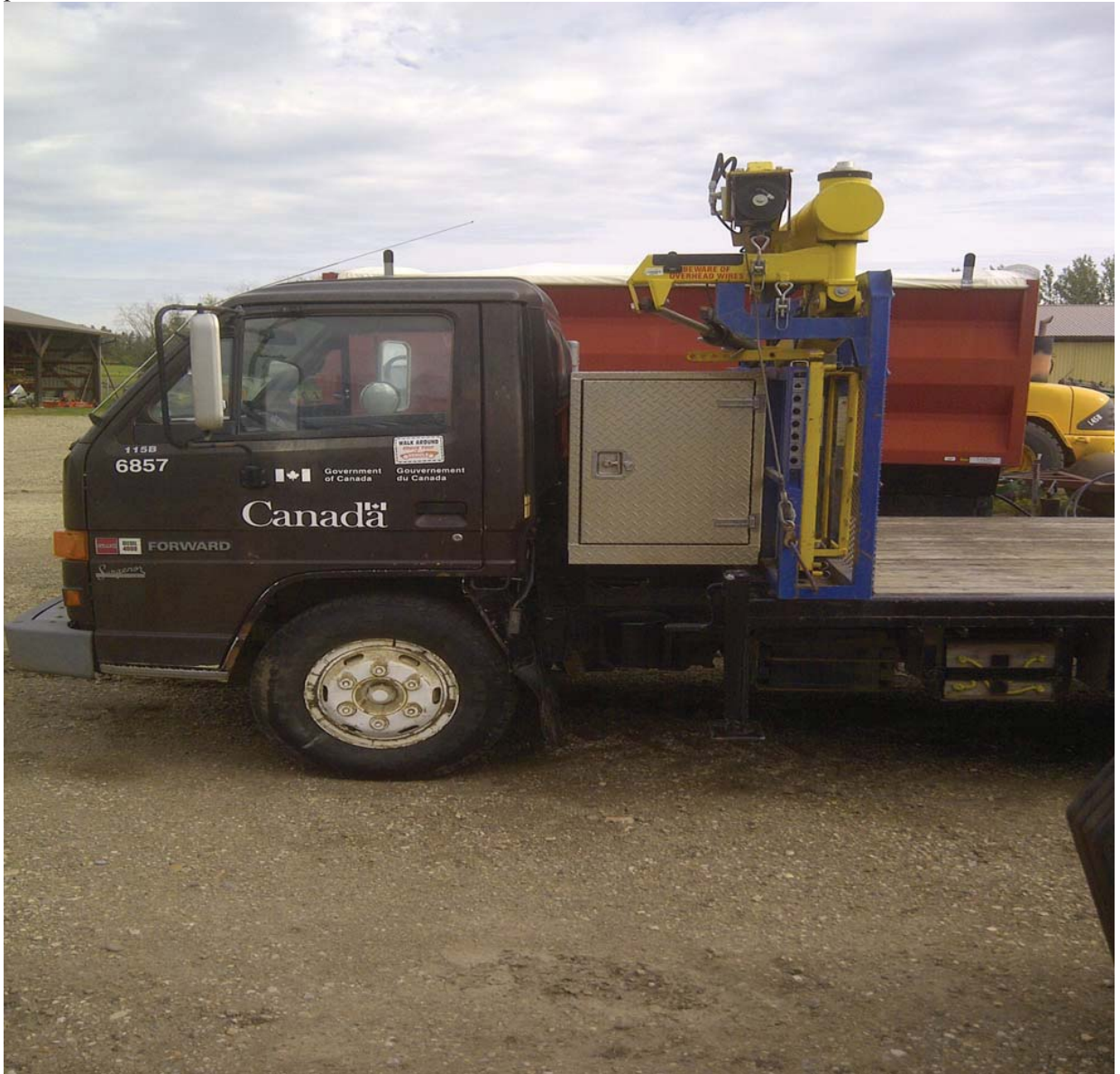
Photo 1 – Configuration actuelle, grue existante et boîte à outils à installer sur la nouvelle plateforme.
