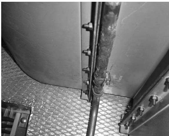
Canalisation de refroidissement tribord du tube d'étambot
