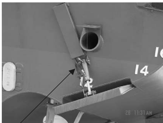
Figure H-03-1 Système de volet de réglage de l'assiette (côté tribord)
