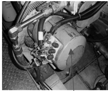
Figure L-01-3 Alternateur bâbord
