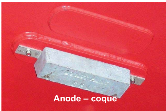
Figure HD-04-1 (10) Anodes de zinc de 10 kg, coque et tableau arrière
