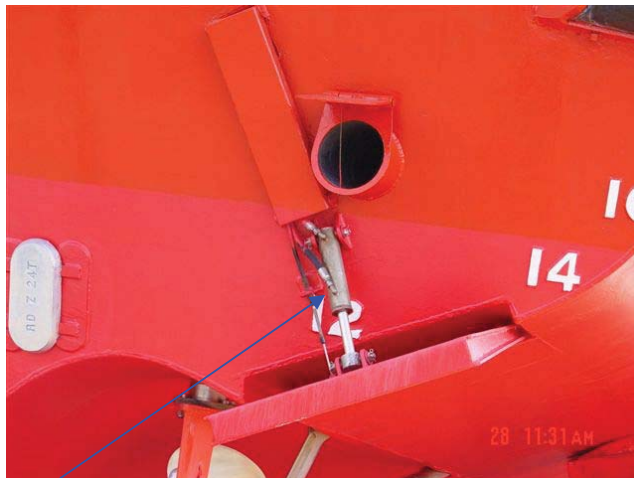
Figure HD-06-1 Volet de réglage de l'assiette de tribord
