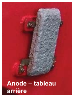
Figure HD-04-1 (10) Anodes de zinc de 10 kg, coque et tableau arrière
