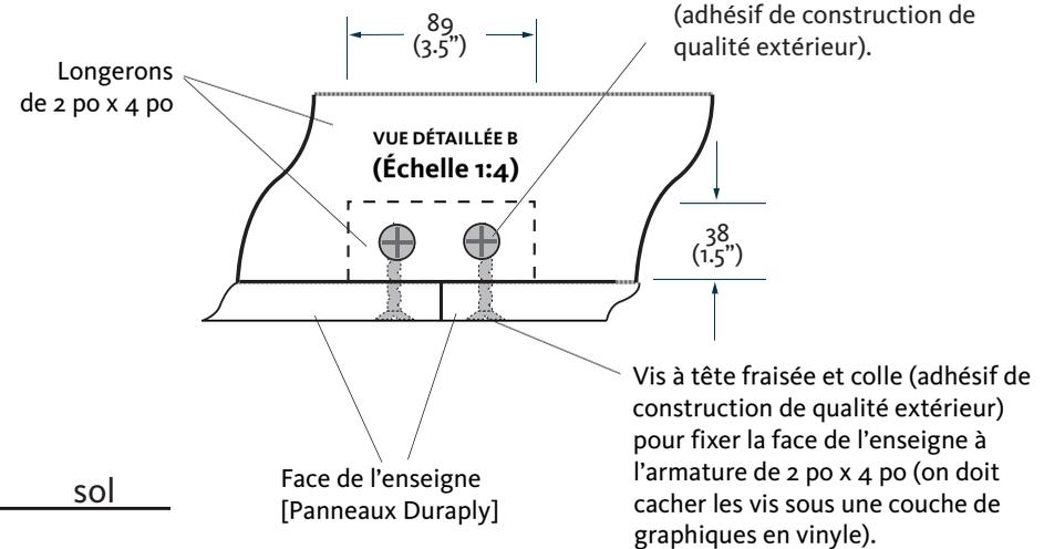
**MATÉRIEL :** Vinyle réflecteur adhésif de qualité extérieur (pellicule réfléchissante de catégorie technique 3M no 3290) monté sur trois panneaux Duraply de 6 pi x 4 pi [16 mm (3/4 po) d'épaisseur] et fixé à l'armature en cèdre (on doit pouvoir utiliser les panneaux de signalisation pendant plusieurs années dans un environnement extérieur).
