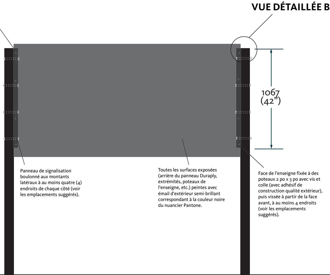
Panneau de signalisation boulonné aux montants latéraux à au moins quatre (4) endroits de chaque côté (voir les emplacements suggérés).
