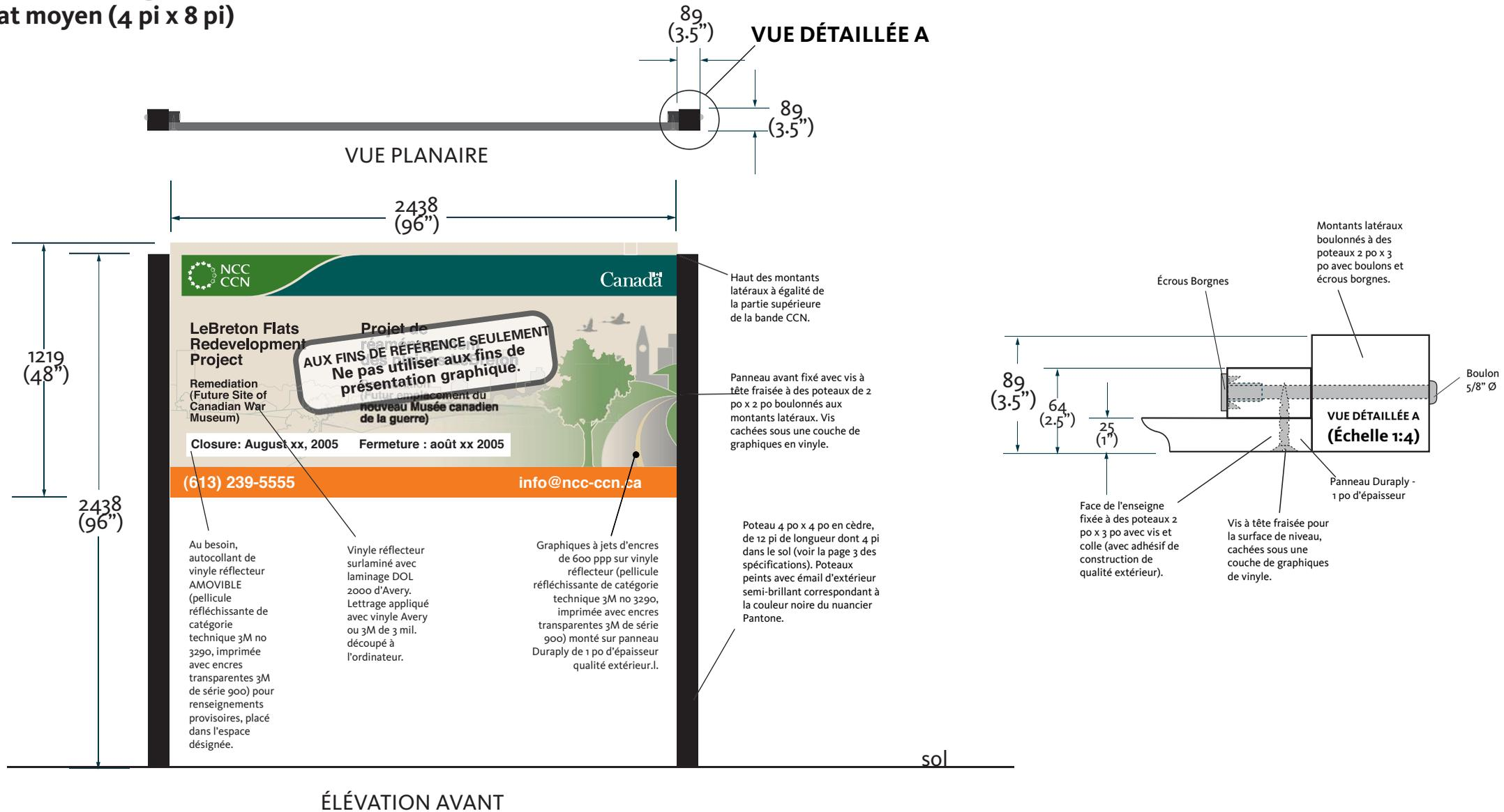
**MATÉRIEL :** Vinyle réfléchiteur adhésif d'extérieur (pellicule réfléchissante de catégorie technique 3M no 3290) monté sur un panneau Duraply [25 mm (1 po) d'épaisseur] et fixé à une armature en cèdre (on doit pouvoir utiliser les panneaux de signalisation pendant plusieurs années dans un environnement extérieur).
