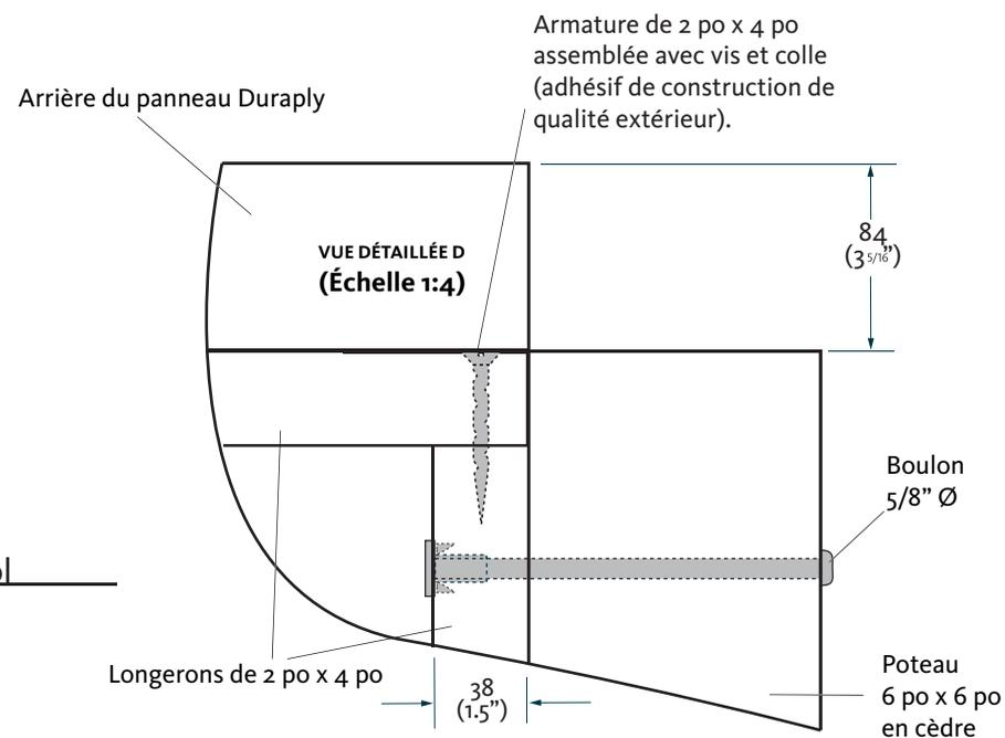
**MATÉRIEL :** Vinyle réflecteur adhésif de qualité extérieur (pellicule réfléchissante de catégorie technique 3M no 3290) monté sur trois panneaux Duraply de 6 pi x 4 pi [16 mm (3/4 po) d'épaisseur] et fixé à l'armature en cèdre (on doit pouvoir utiliser les panneaux de signalisation pendant plusieurs années dans un environnement extérieur).
