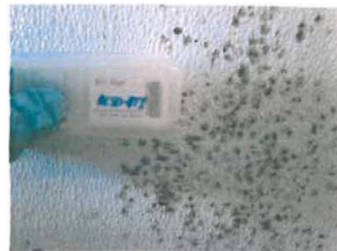
Photo 4 Formation modérée de moisissures observées et identifiées sur le mur de la cuisine Échantillon RESO-BT1
