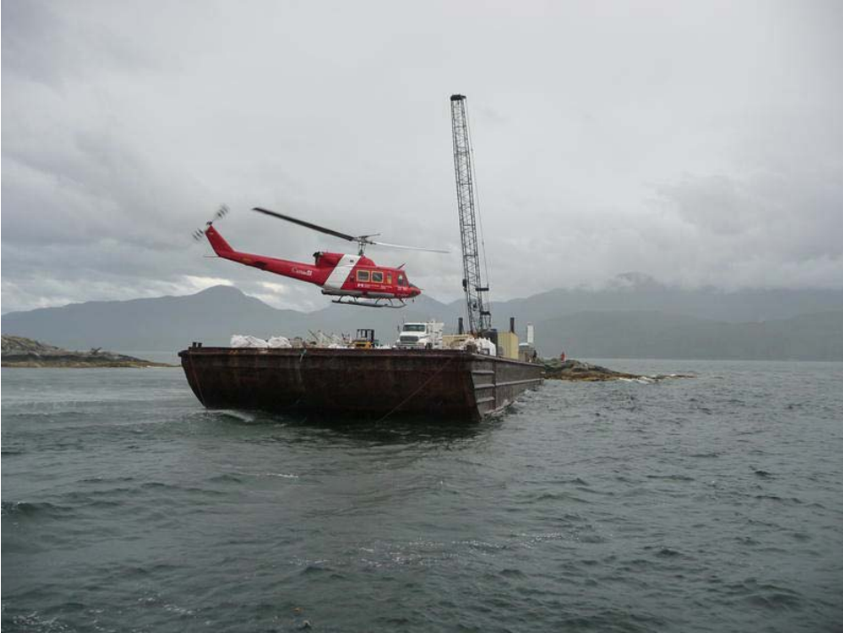
Figure 2. Exemple du type de barge qui sera utilisé à contrat par Parcs Canada et à partir duquel seront effectuées les opérations hélicoptérées et de chargement du godet de l'épandeur d'appâts. Les dimensions de cette barge seront d'environ 150 X 42 pieds.
