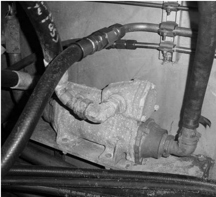
Figure E-02-1 – Refroidisseur de transmission
