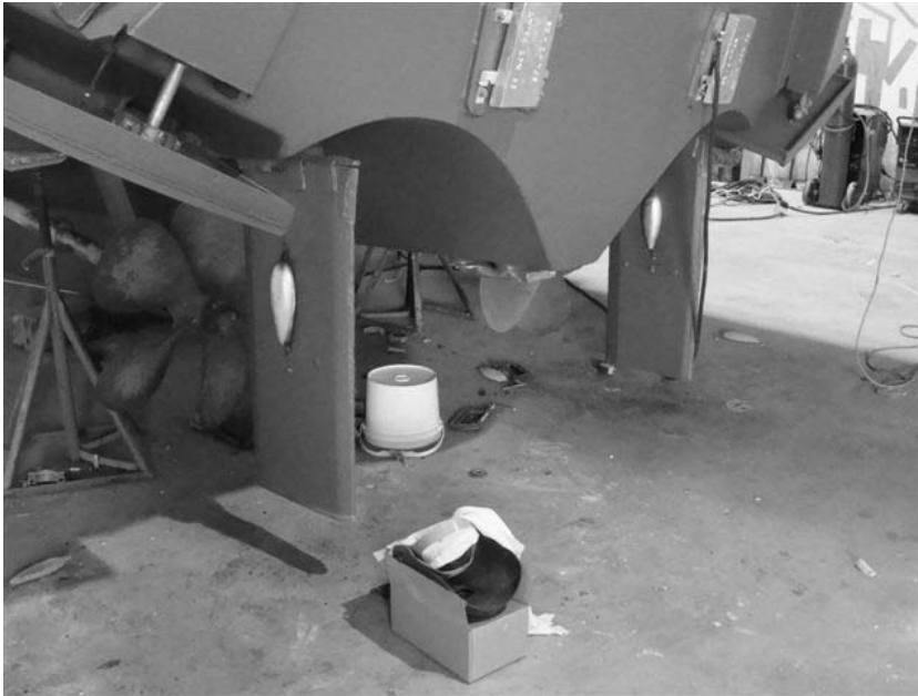
Figure H-06-2 – Gouvernail (vue de la mèche de gouvernail)
