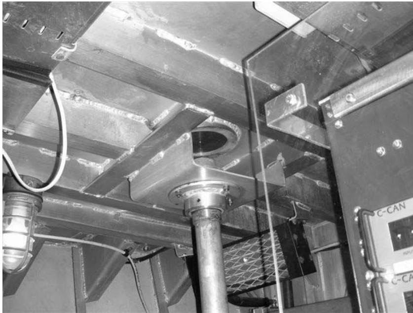
Figure H-06-1 – Tige de rallonge de l'appareil à gouverner d'urgence
