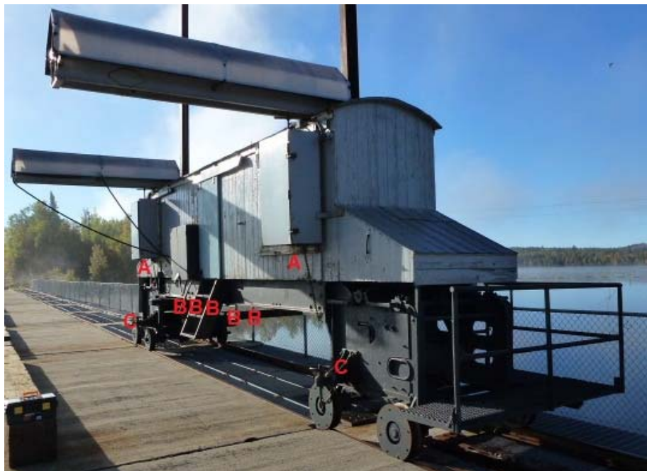
Figure 1 - Chariot-treuil en regardant vers l'amont. « A » représente l'emplacement approximatif de nouveaux ancrages du système de protection contre les chutes. « B » représente emplacements approximatifs des traverses situées dans le châssis qui nécessitent des consoles de support à leurs extrémités. « C » désigne les dispositifs du chariot-treuil qui s'engagent avec des ancrages de tablier.
