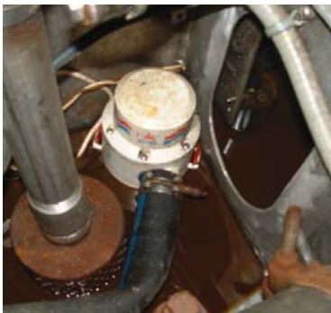
HD-05-Fig. 3 et Fig. 4 – Pompes immergées de la salle des machines (bâbord – gauche, tribord – droite)
