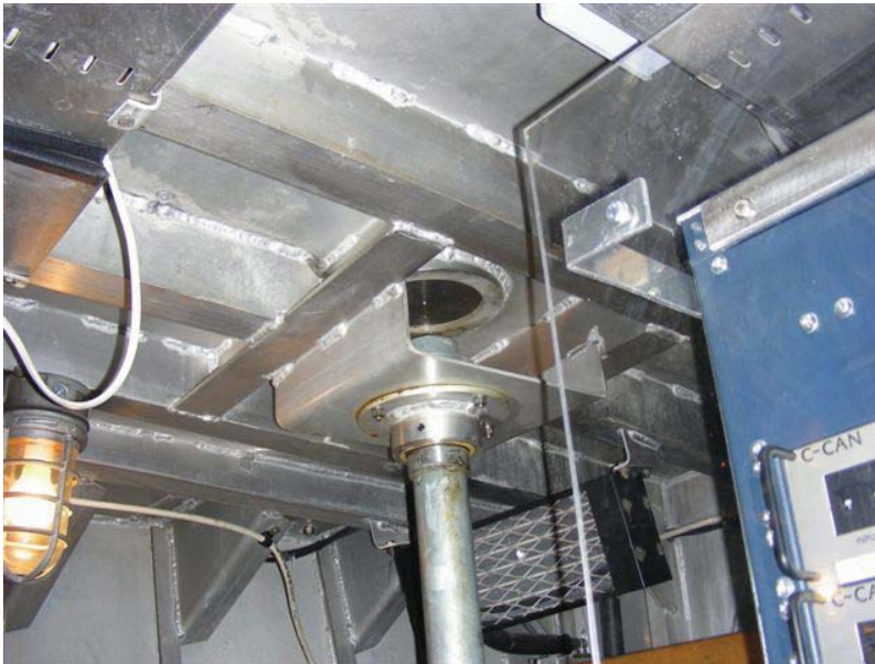
Figure H-06-Fig. 1 – Tige de rallonge de l'appareil à gouverner d'urgence
