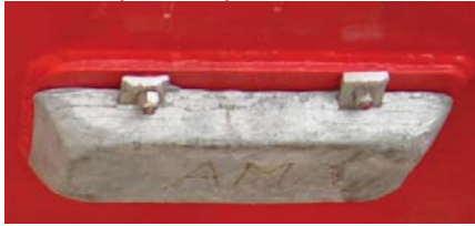
Figure HD-04-Fig. 1 - Anode en zinc (10 kg) pour la coque/le tableau
