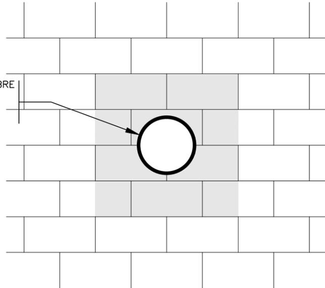
DÉFONCER LA PAROI DE FACE AU BESOIN POUR REMPLIR DE COULIS LES ALVÉOLES DES BLOCS SOUS L'APPUI DES CORNIÈRES DE CHAQUE CÔTÉ DE L'OUVERTURE. METTRE DU COULIS SUR TOUT LE POURTOUR DE L'OUVERTURE.
