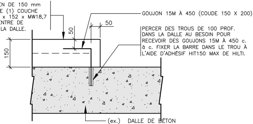
PERCER DES TROUS DE 100 PROF. DANS LA DALLE AU BESOIN POUR RECEVOIR DES GOUJONS 15M À 450 c. à c. FIXER LA BARRE DANS LE TROU À L'AIDE D'ADHÉSIF HIT150 MAX DE HILTI.
