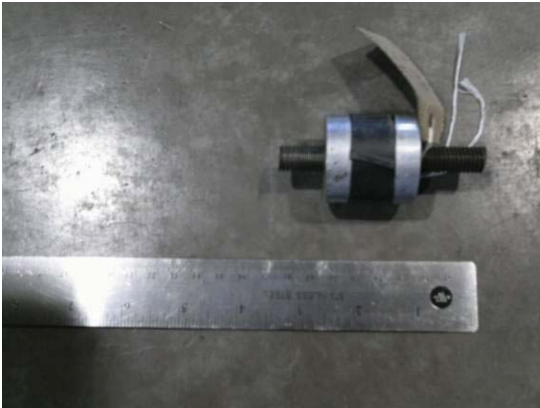
Figure 7 – Pièce d'espacement M12
