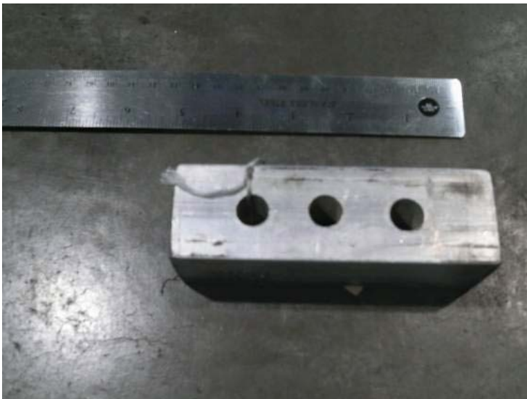
Figure 8 – Pièce d'espacement de module à barre carrée
