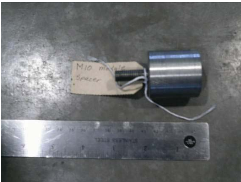
Figure 9 – Pièce d'espacement M10
