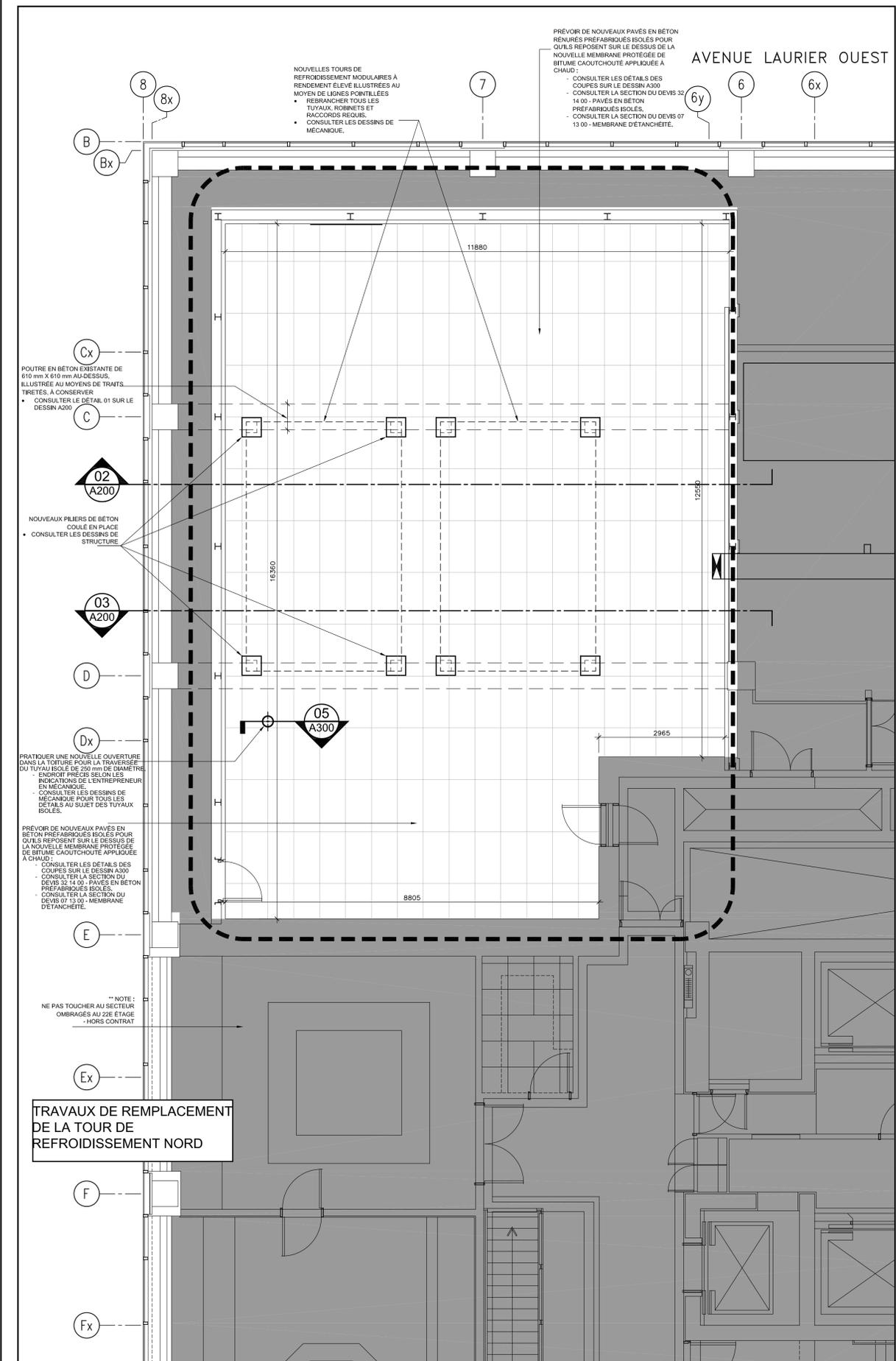
02 PLAN PARTIEL DES NOUVEAUX TRAVAUX DE Puits DE LA TOUR DE REFROIDISSEMENT NORD SUR LA TOITURE - 22<sup>e</sup> ÉTAGE
