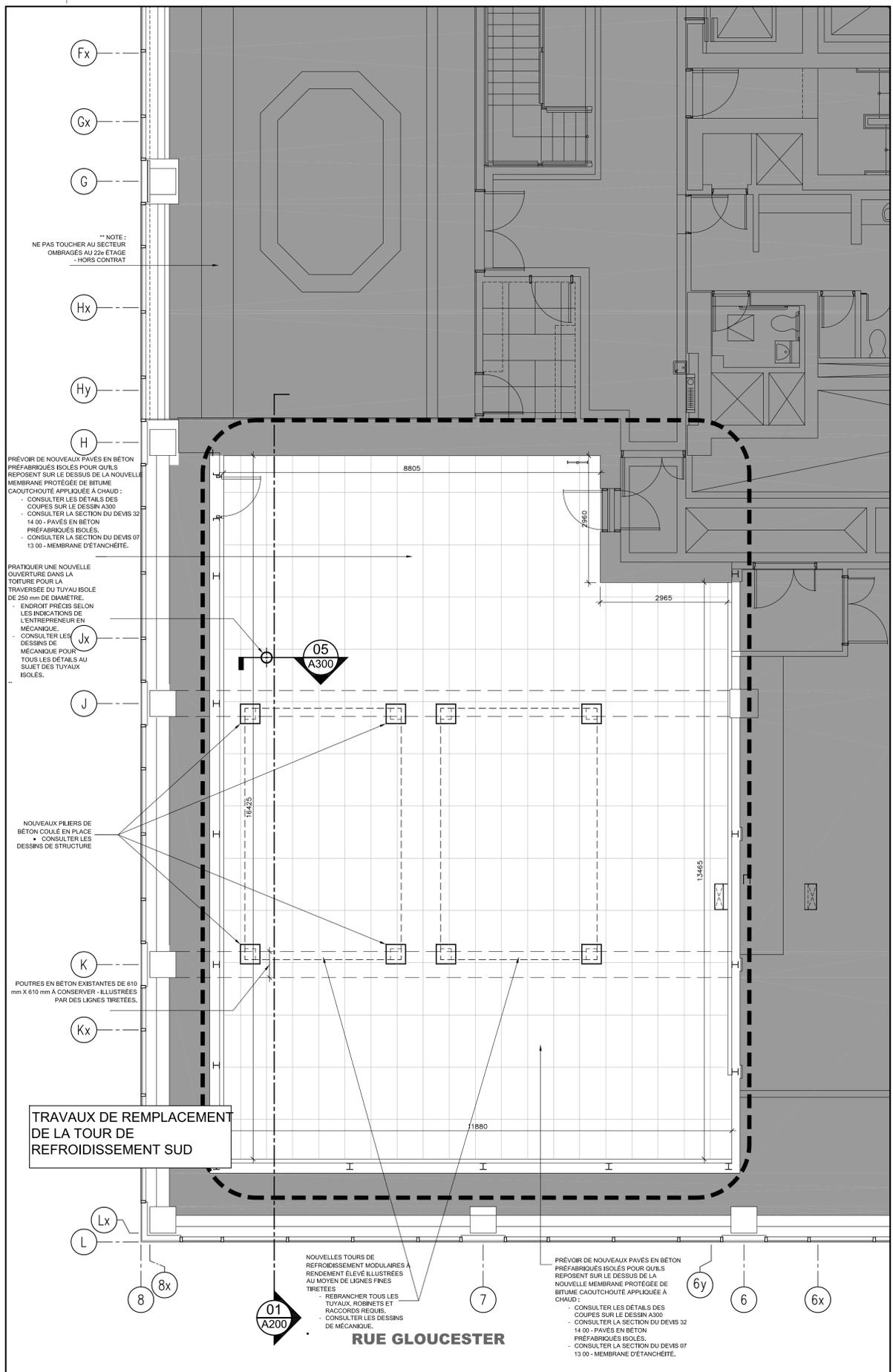
01 PLAN PARTIEL DES NOUVEAUX TRAVAUX DANS LE Puits DE LA TOUR DE REFROIDISSEMENT SUD SUR LA TOITURE - 22<sup>e</sup> ÉTAGE
