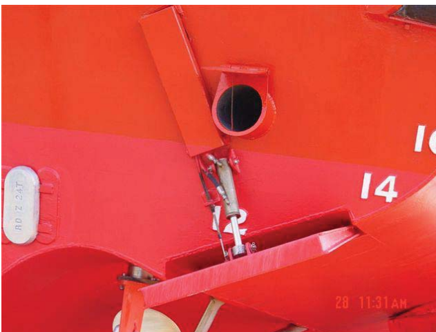
Figure HD-08-Fig. 1 Système de volet de réglage de l'assiette (côté tribord)
