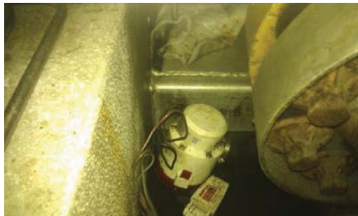
HD-05-Fig. 3 et Fig. 4 – Pompes immergées de la salle des machines (bâbord – gauche, tribord – droite)
