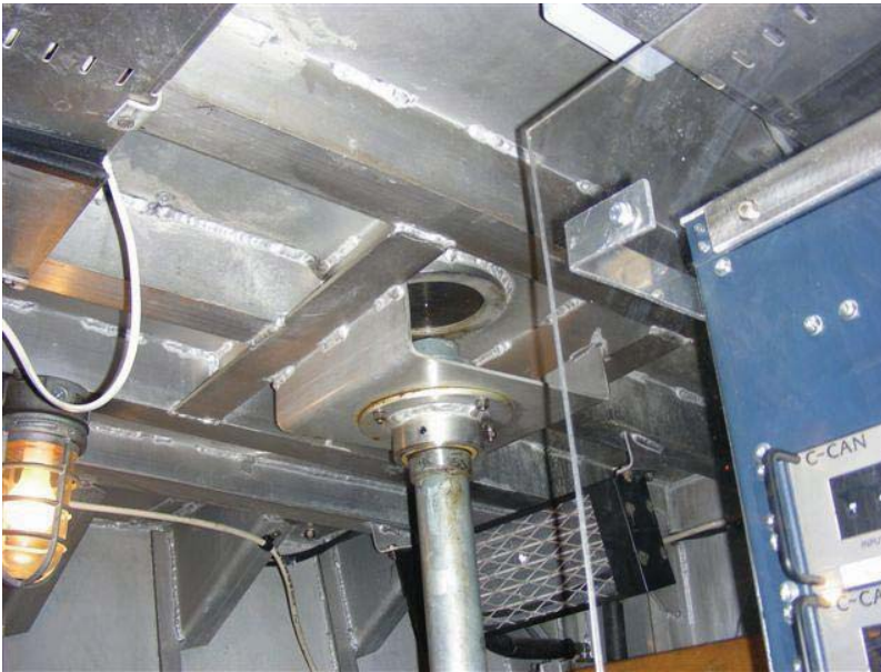
Figure H-06-Fig. 1 – Tige de rallonge de l'appareil à gouverner d'urgence
