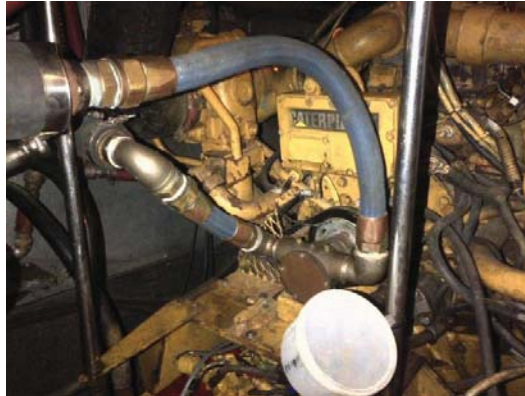
HD-05-Fig. 2 – Tuyauterie de la pompe à incendie
