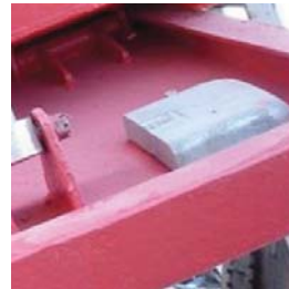
Figure HD-04-Fig. 3 - Anodes pour gouvernail et volet de réglage
