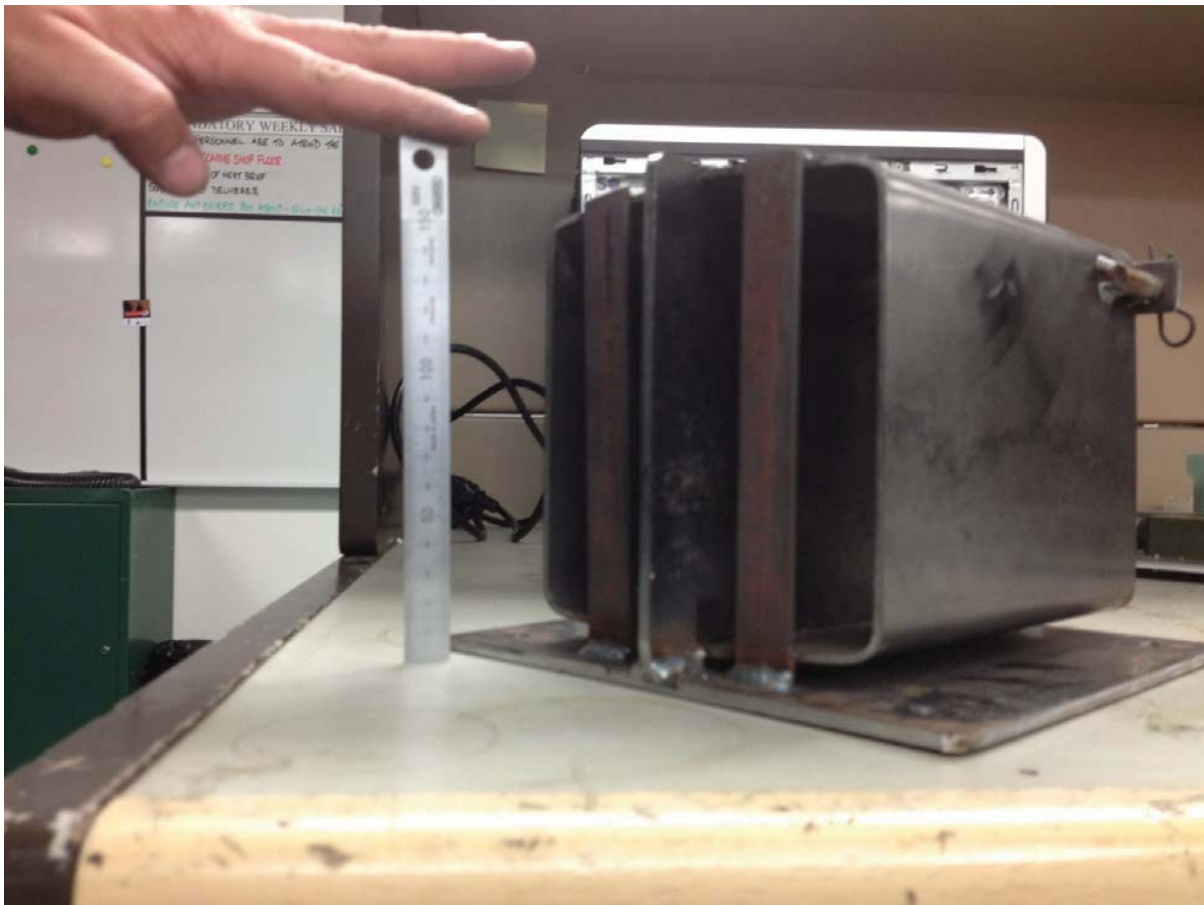
Photo #5 Boîtes de protection pour convertisseur DC-DC. Aluminium.
