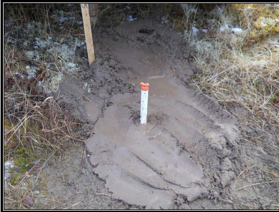
Photo 5 : Tube d'observation installé dans le forage TF-05-12.
