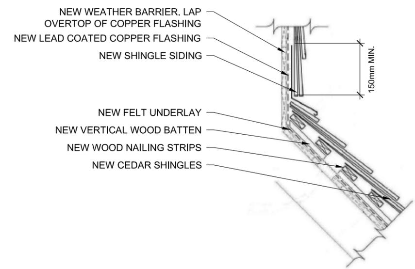
4 SHINGLE ROOF @ SHINGLE WALL DETAIL
