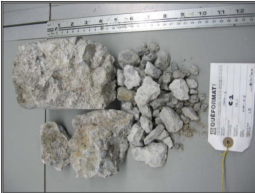
Photographie no 3 : Traverse amont FA. Carotte de la base de béton sur sol. Carotte C-2 (0,00 à 0,16 mètre de profondeur).
