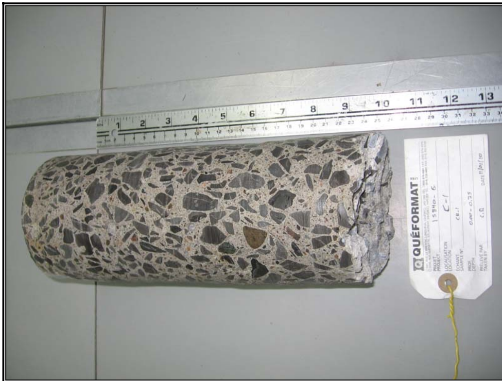
Photographie no 1 : Traverse amont FA. Carotte de la base de béton hors-sol. Carotte C-1 (0,00 à 0,25 mètre de profondeur).
