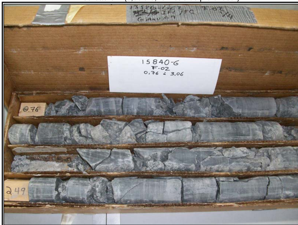
Photographie no 4 : Traverse amont FA. Carotte du roc. Forage F-02 (0,76 à 3,06 mètres de profondeur).
