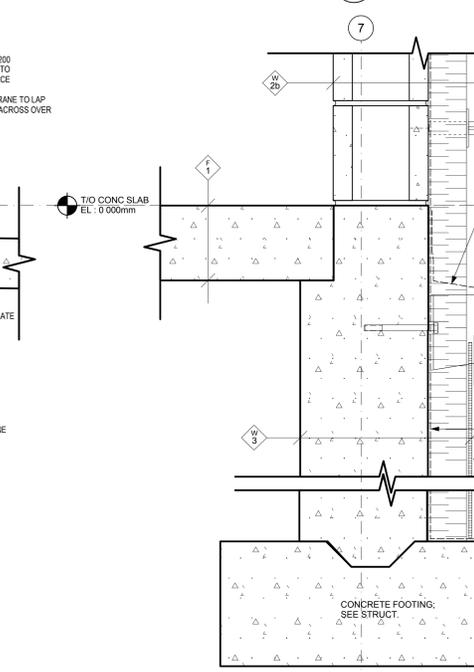
V TYP. BLOCK WALL @ CELLS ON GRID 7
