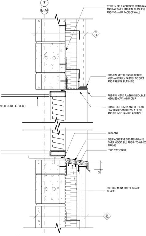
R TYP. BLOCK WALL MECH. LOUVER SECTION
