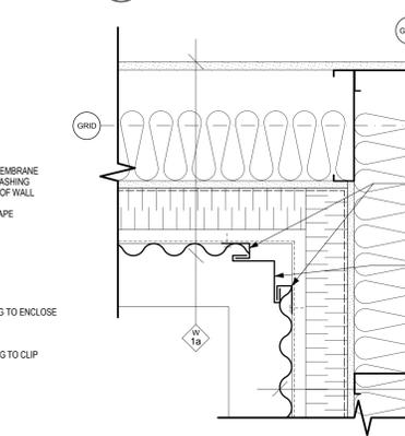
WW TYPICAL EXTERIOR WALL CORNER DETAIL
