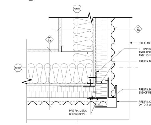
W TYPICAL EXTERIOR WALL CORNER DETAIL
