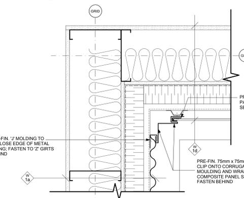
X TYPICAL PANEL SYSTEM OUTSIDE CORNER DETAIL
