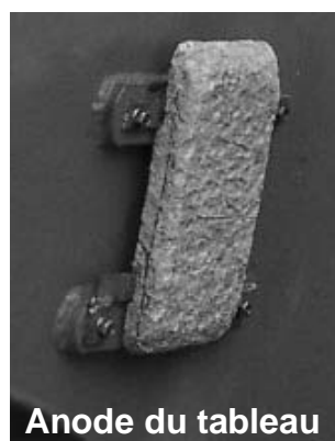
Figure HD-04-1 : Anodes de zinc (10 kg) de la coque et du tableau
