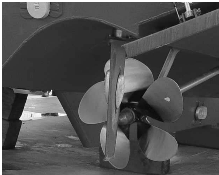
Figure H-03-1 : Gouvernail (vue de la mèche de gouvernail)
