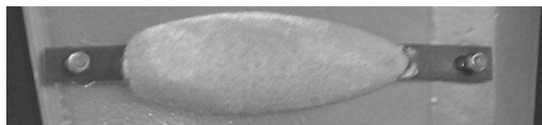
Figure HD-04-3 : Anode de gouvernail
