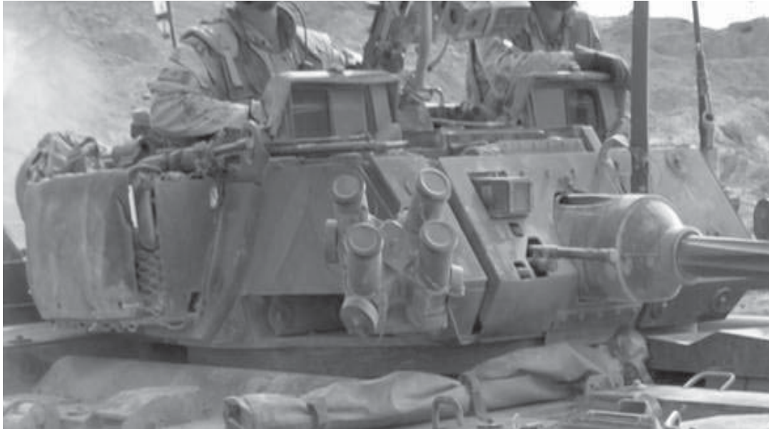
Figure 1 – Ligne de toit d'une tourelle dépourvue d'un ensemble de protection pour les membres d'équipage exposés (ECPK)
