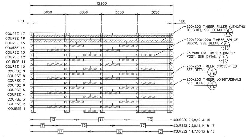
TYPICAL ELEVATION OF CRIB No.1 & 3
