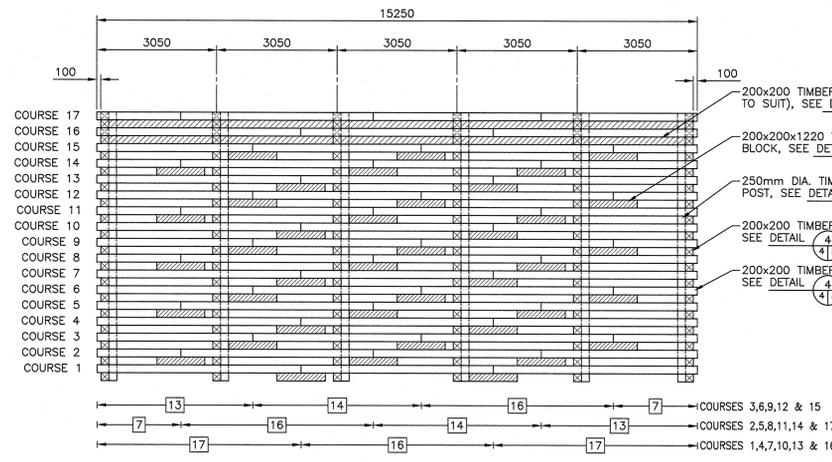
TYPICAL ELEVATION OF CRIB No.2
