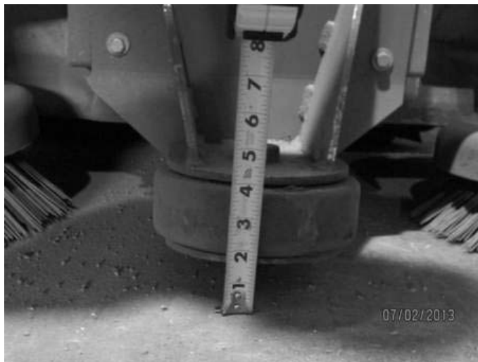
Figure 2 : Roue de guidage sur le véhicule existant
