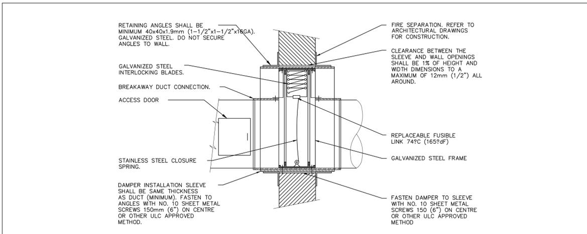
1 FIRE DAMPER INSTALLATION DETAIL
