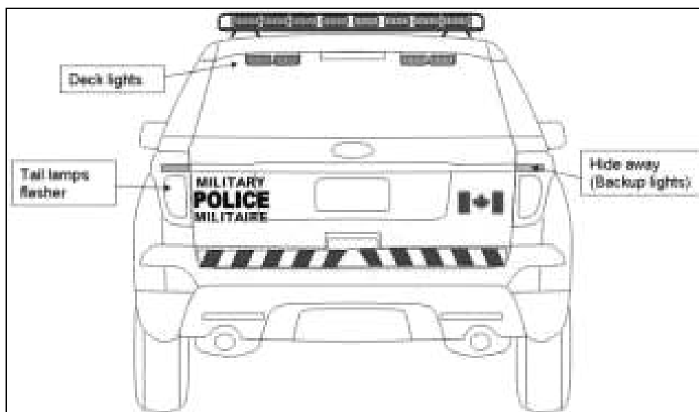
Figure 8 – Feux d'urgence requis sur les véhicules de la PM – vue arrière.
