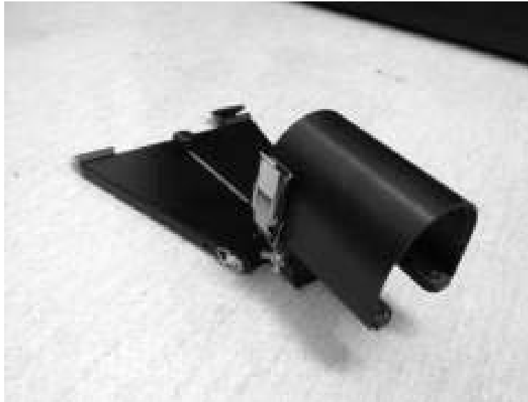
Figure 8 – Support de tableau de bord pour radar Stalker II
