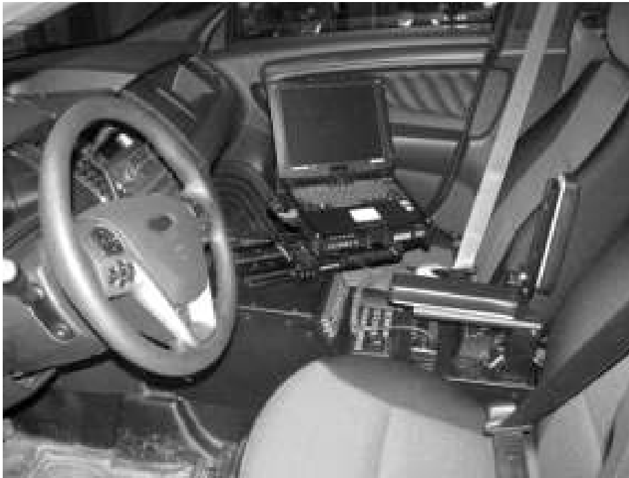
Figure 4 – Disposition du terminal de données mobile
