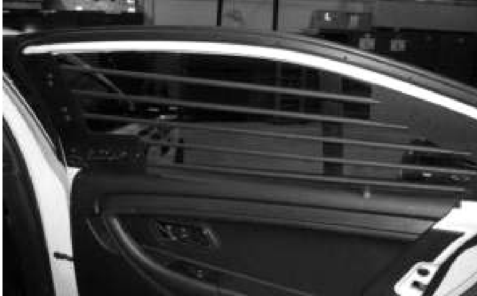
Figure 10 – Barreaux de fenêtre (type de barreaux de prédilection. Photo d'une berline)
