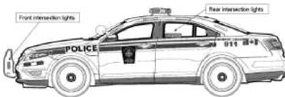
Figure 1 – Feux d'urgence requis sur les véhicules de la PM – vue latérale.
