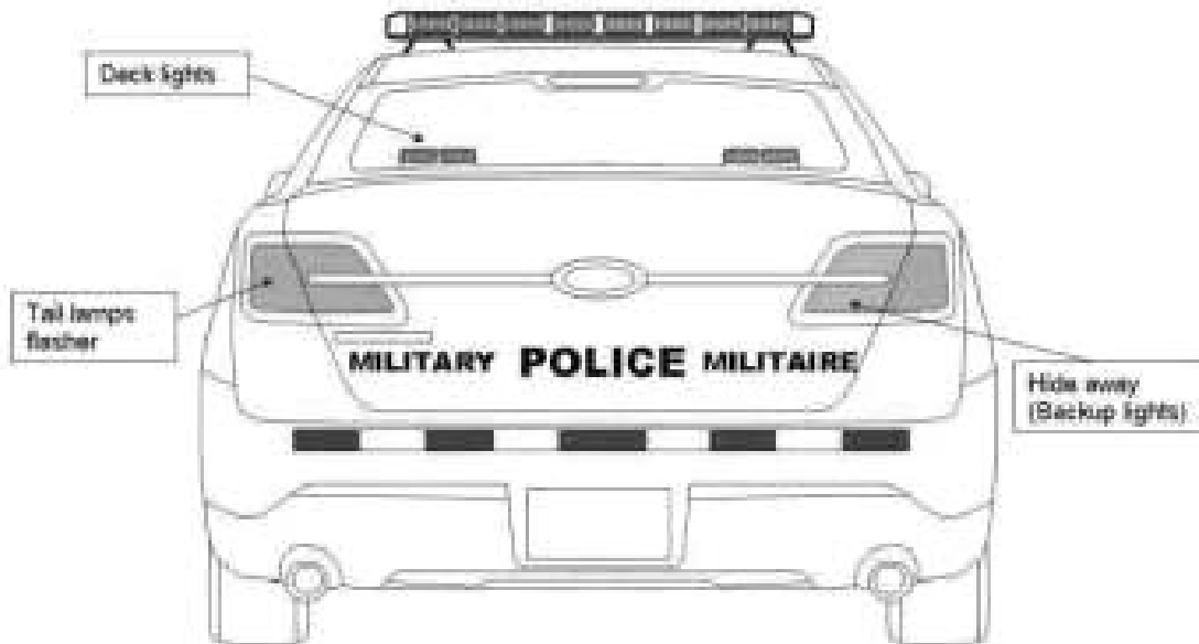
Figure 3 – Feux d'urgence requis sur les véhicules de la PM – vue arrière.
