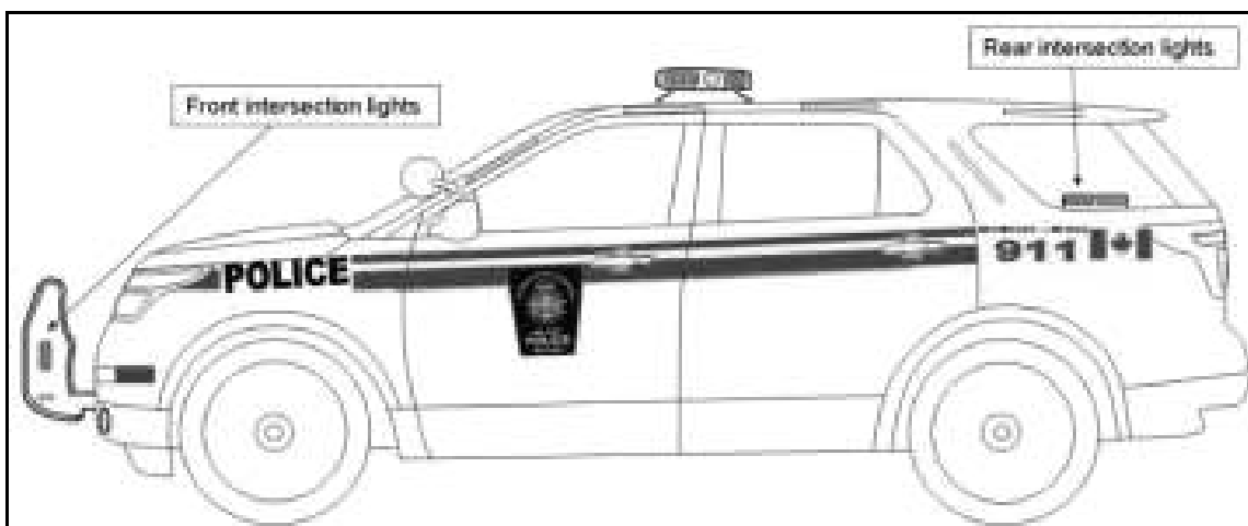
Figure 6 – Feux d'urgence requis sur les véhicules de la PM – vue latérale.
