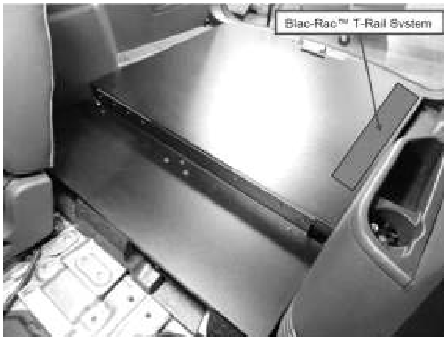
Figure 8 — Le support Black-Rac modèle doit être installé dans l'espace de chargement arrière tel qu'illustré ci-dessus.
