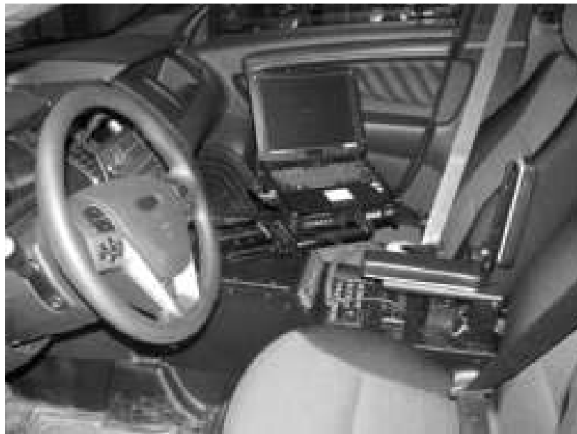
Figure 1 – Exemple de console centrale ergonomique inclinée
