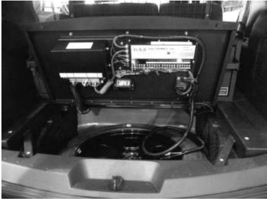
Figure 1 – D& R Electronics – Installation du panneau de montage pour matériel électronique sous le plancher.
