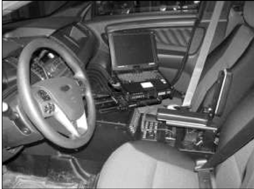
Figure 5 – Disposition du terminal de données mobile, préférer mobile Havis
