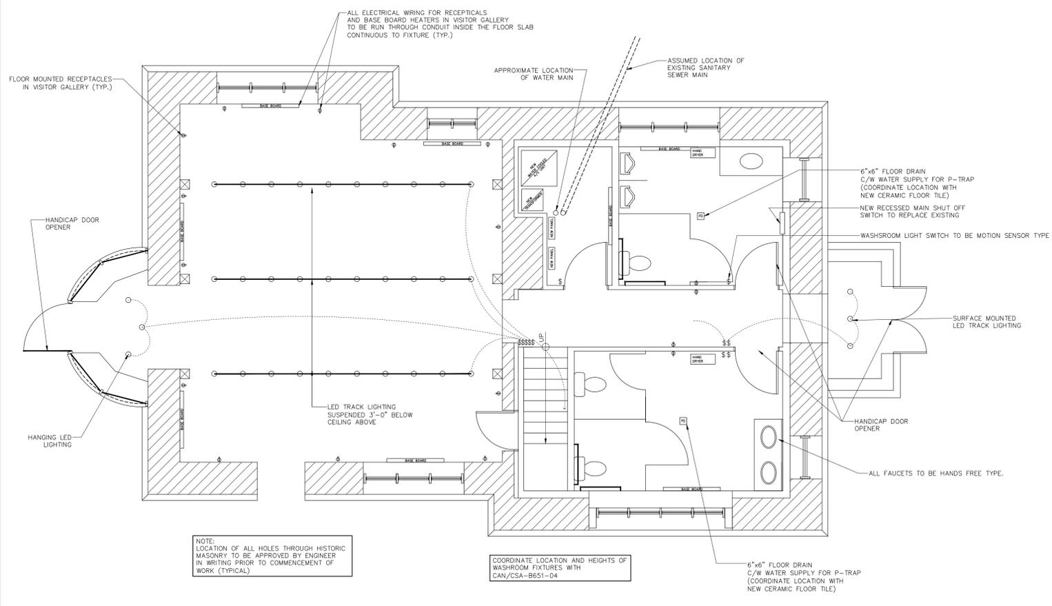
GROUND FLOOR PLAN - ELECTRICAL / PLUMBING
