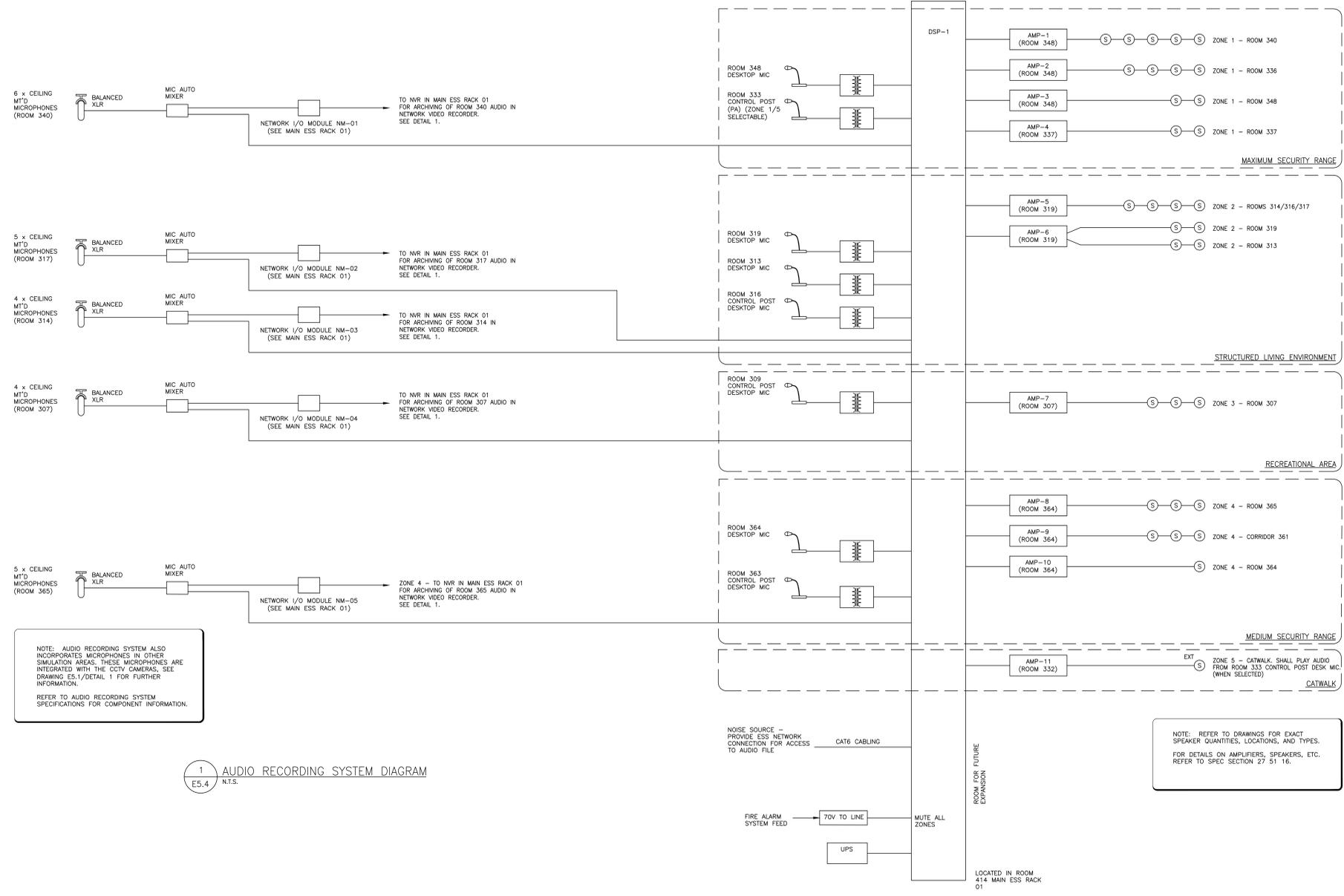
NOTE: AUDIO RECORDING SYSTEM ALSO INCORPORATES MICROPHONES IN OTHER SIMULATION AREAS. THESE MICROPHONES ARE INTEGRATED WITH THE CCTV CAMERAS. SEE DRAWING E5.1/DETAIL 1 FOR FURTHER INFORMATION.
