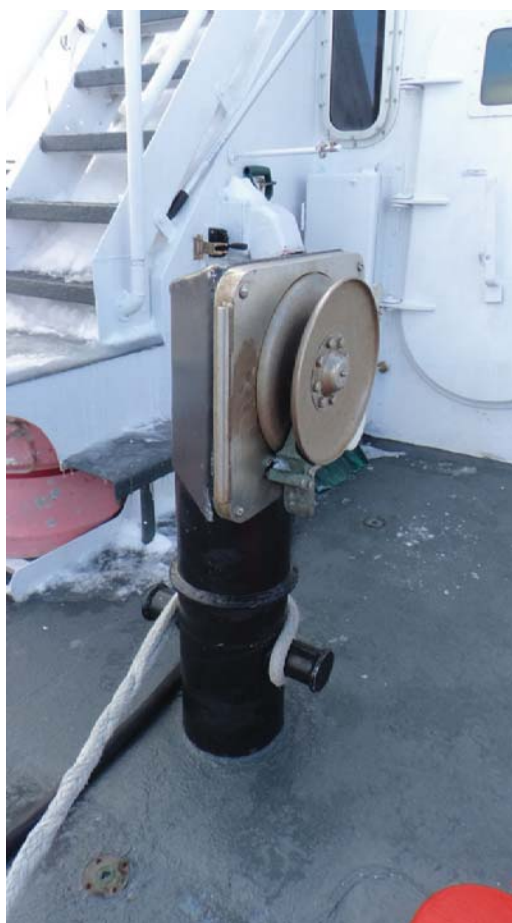
Figure 2 Treuil de remorquage installé sur le bateau jumeau
