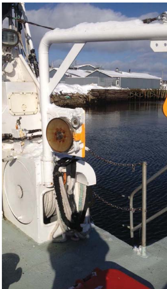
Figure 1 Treuil de remorquage installé sur le bateau
