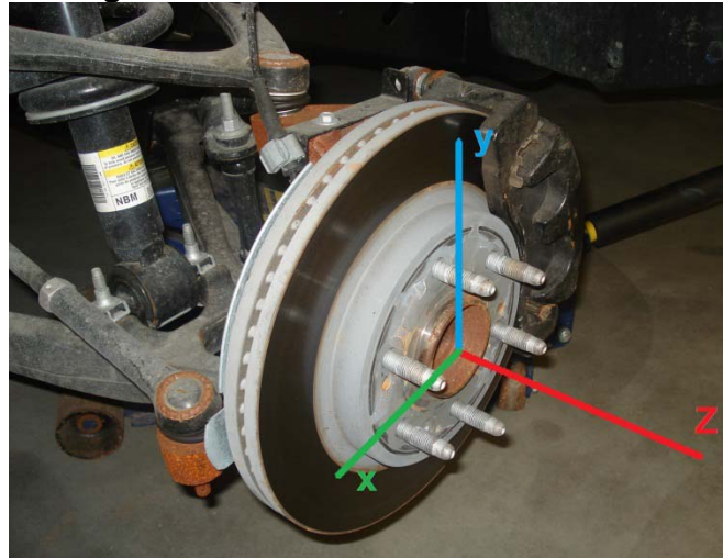
Figure 1 : Orientation des axes de roue
