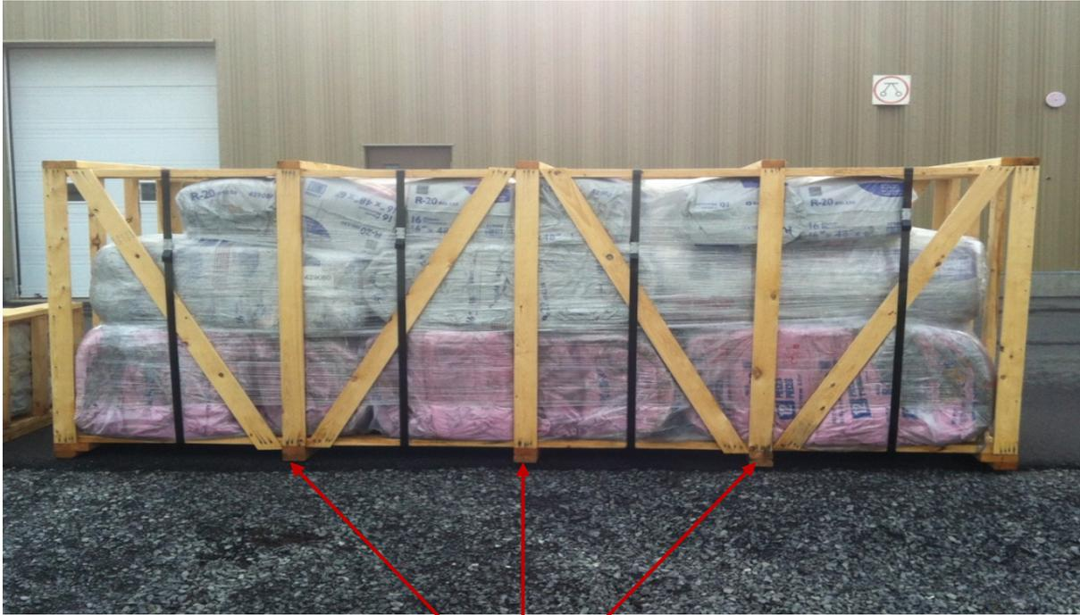
*Des patins de 4" x 4" sont nécessaires sous le caisson pour permettre la manutention au chariot élévateur. Ils devraient être placés à intervalles égales sous le caisson.*
