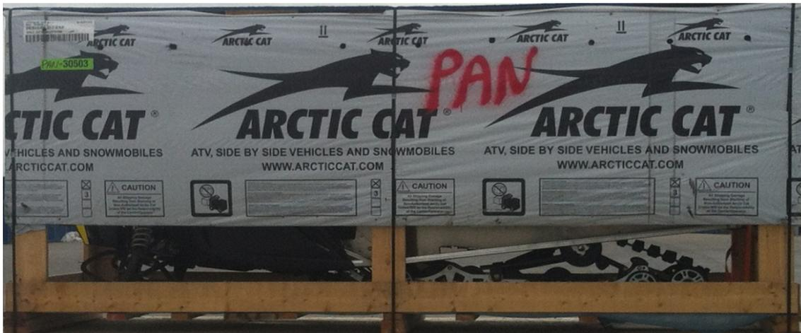
1. Des patins 4" x 4" sont nécessaires sous le caisson pour la bonne manutention au chariot élévateur.
