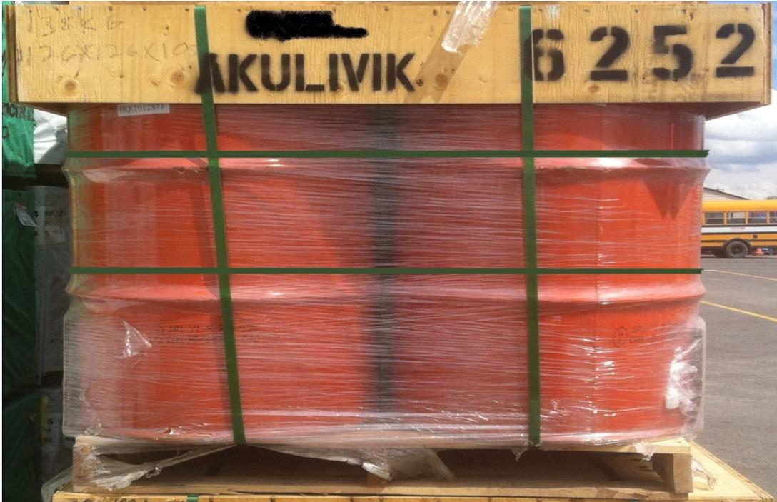
1. *Quatre (4) sangles d'acier devraient être installées sur les barils. Deux (2) sangles verticales placées au centre des barils et deux (2) sangles horizontales entourant les barils.*
