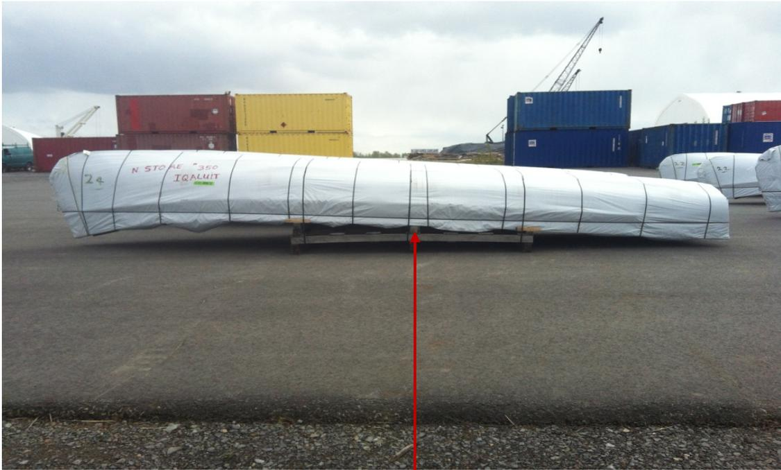
*Des patins de 4" x 4" sont nécessaires sous le canoë pour permettre la manutention au chariot élévateur. Ils devraient être placés à intervalles égales sous le canoë.*
