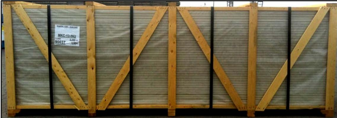
*Des patins de 4" x 4" sont nécessaires sous le caisson pour permettre la manutention au chariot élévateur. Ils devraient être placés à intervalles égales sous le caisson.*
