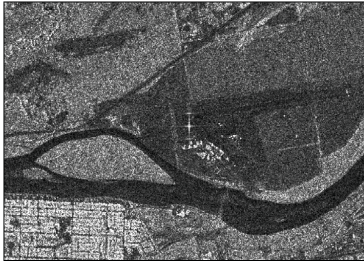
Figure 1 Réponse d'un transpondeur installé sur le terrain de l'aéroport de Prince Albert (Saskatchewan), visible dans une scène de RADARSAT-1.
