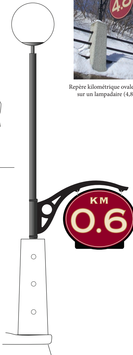
Détail d'un repère kilométrique ovale installé sur un lampadaire (échelle 1:25)
