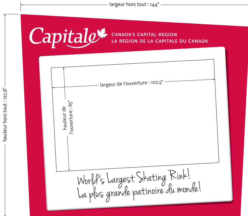
Maquette du panneau illustré du prototype de structure pour la prise de photos (1:30)
