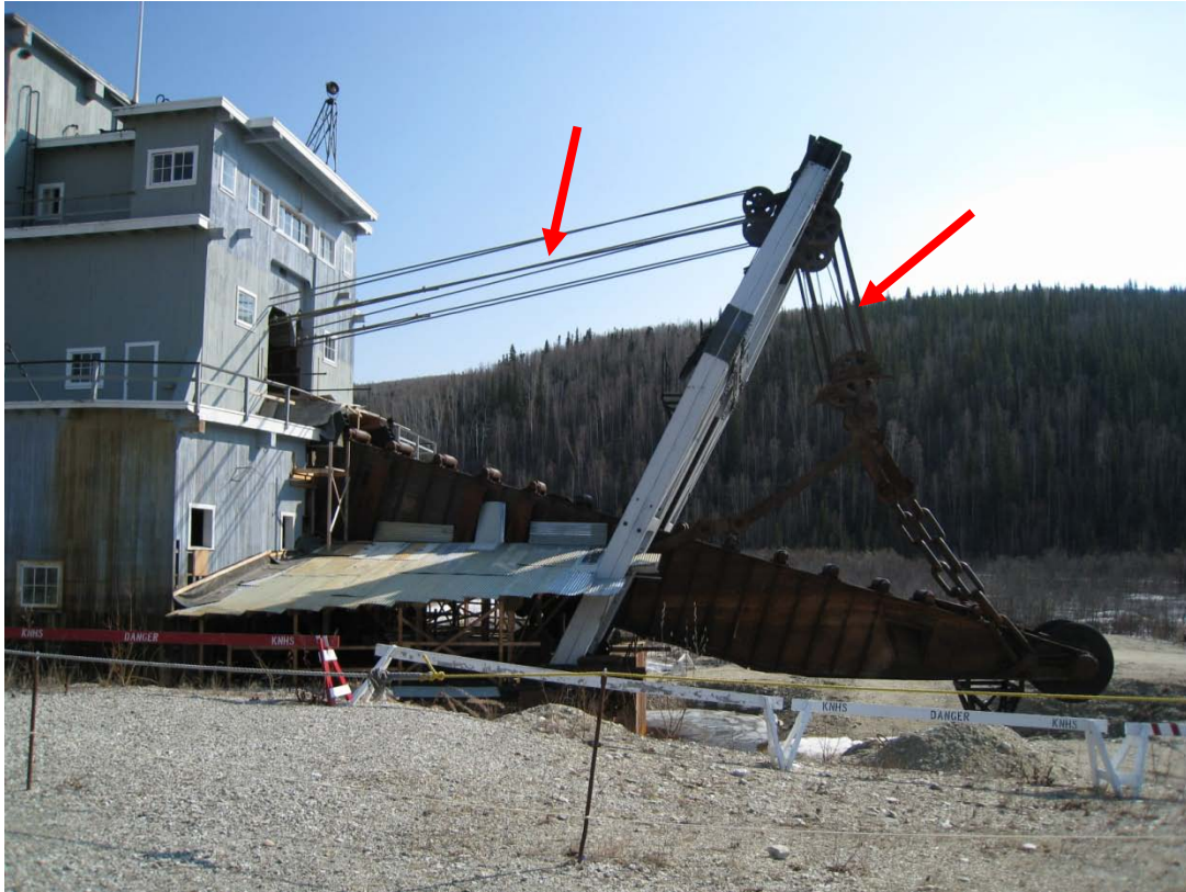
Figure 11 Vue de côté du système de soutien du portique avant et du bras d'excavation
