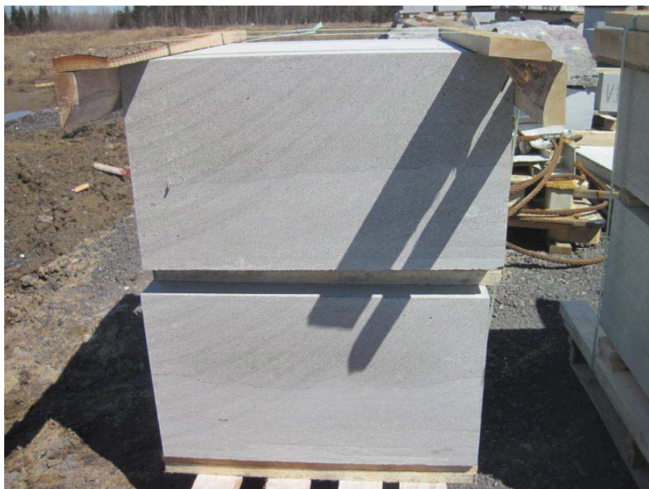
Fig. 3. Pierres de pilier inacceptables et ce, compte tenu d'un épais lit de calcaire argileux se prolongeant au milieu de chaque pierre
