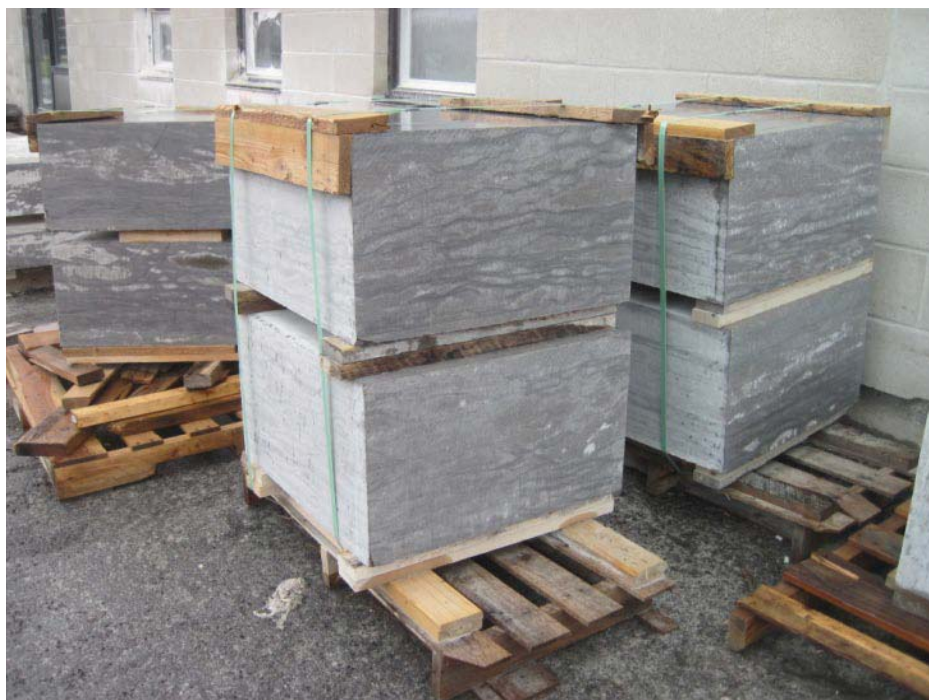
Fig. 6. Pierres de pilier inacceptables, présentant des lits d'argile rugueux et complexes.
