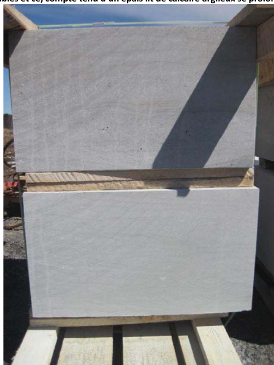
Fig. 4. Tolérances acceptables de la pierre. La pierre du bas présente un matériau de bonne qualité : se caractérise par de minces filons d'argile parmi de nombreux éléments grenus, qui sont toutefois décantés et uniformes. La pierre du haut présente des lits écailloux, avec quelques grains ouverts, mais finement lités et acceptables. Par ailleurs, ne seront pas acceptables les zones à grandes surfaces de lits écailloux et présentant une porosité ouverte.
