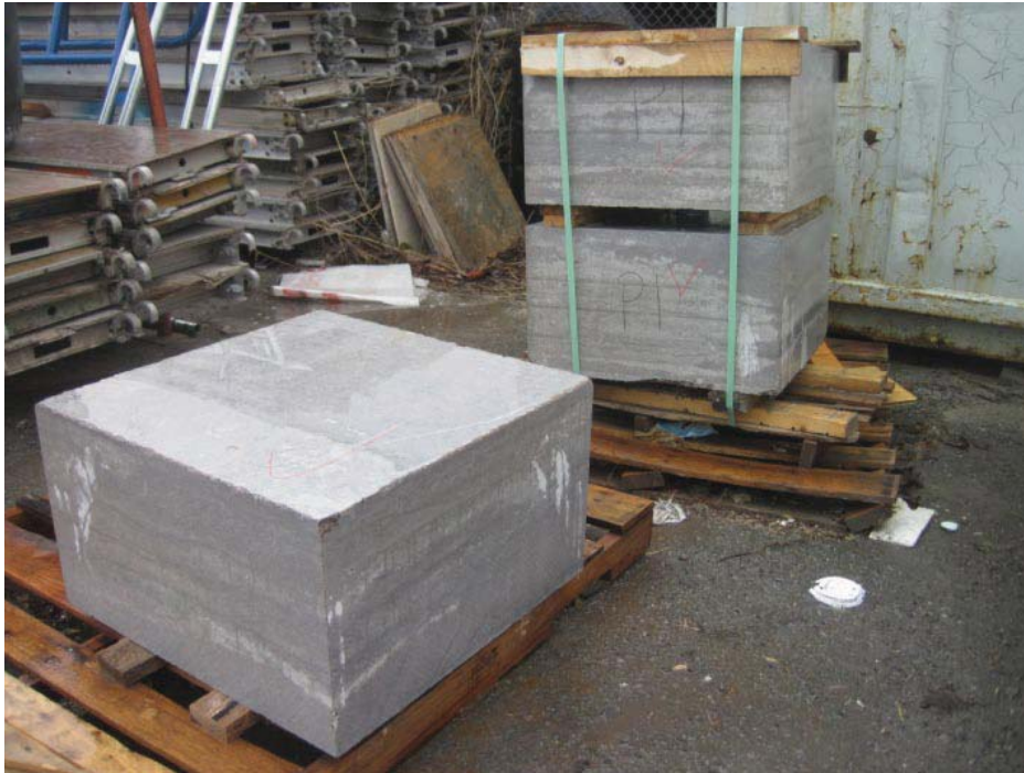
Fig. 7. Pierres de pilier acceptables. La stratification s'avère adéquate et les bandes du litage écailleux sont étroites.
