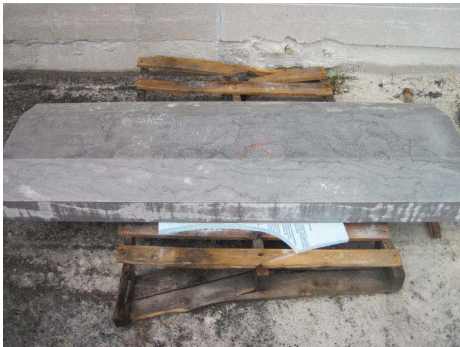
Fig. 5. Exemple d'une pierre de couronnement inacceptable. Lit d'argile excessivement épais et surface supérieure vulnérable, qui sera exposée à des conditions extrêmes.
