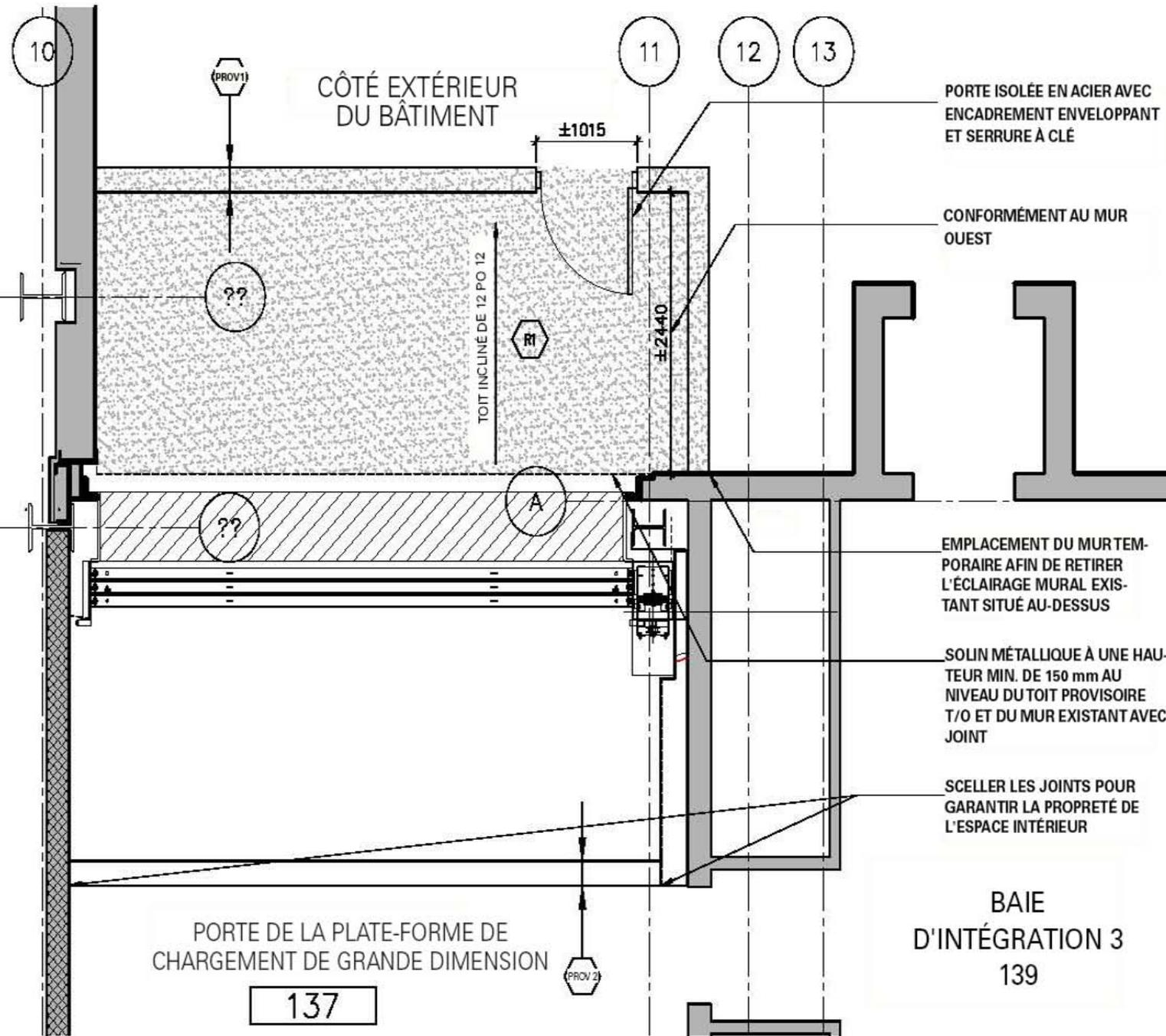
PORTE ISOLÉE EN ACIER AVEC ENCADREMENT ENVELOPPANT ET SERRURE À CLÉ
