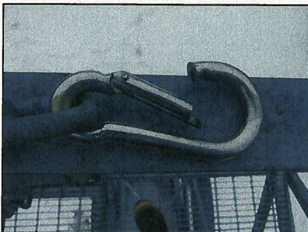
Photo no. 3 – Crochet de sécurité.
