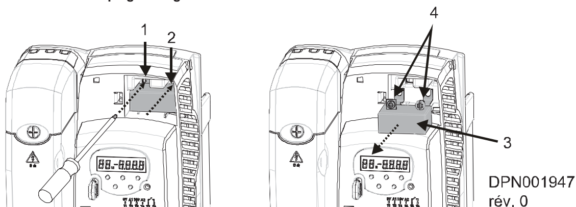
Figure 65 Figure BB – Débranchement du filtre EMC pour les onduleurs de type 2 avec alimentation à couplage triangle
