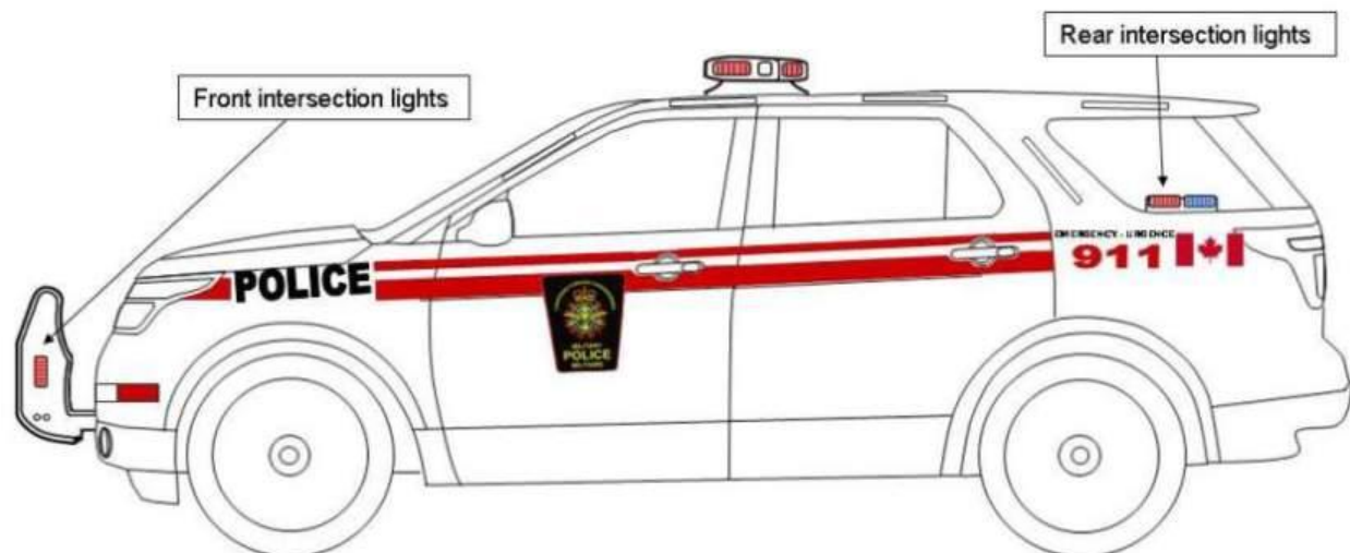
Figure 10 – Véhicule utilitaire Ford Interceptor identifié de la PM équipé d'une barre de feux d'urgence sur le toit (vue latérale)
