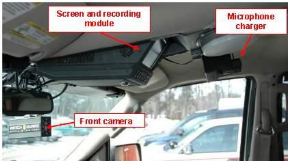
Figure 21 – SEVM, modèle plafonnier (écran, module d'enregistrement, chargeur de microphone et caméra)
