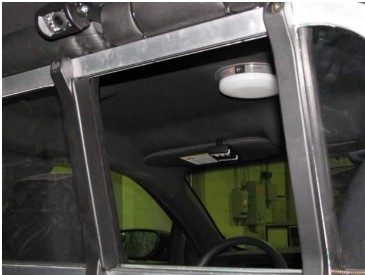
Figure 23 – Écrans de sécurité (avec vitre centrale coulissante et caméra arrière du SEVM)
