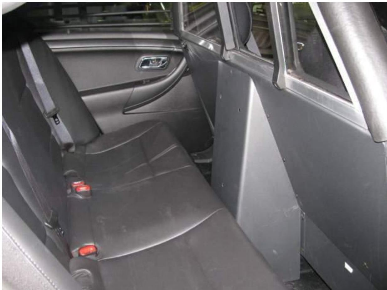
Figure 22 – Écrans de sécurité (équipés de panneau de rangement d'arme encastré et d'une vitre centrale coulissante)
