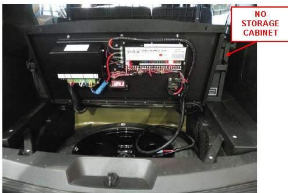
Figure 28A – D & R Electronics – Matériel électronique fixé sous panneau
