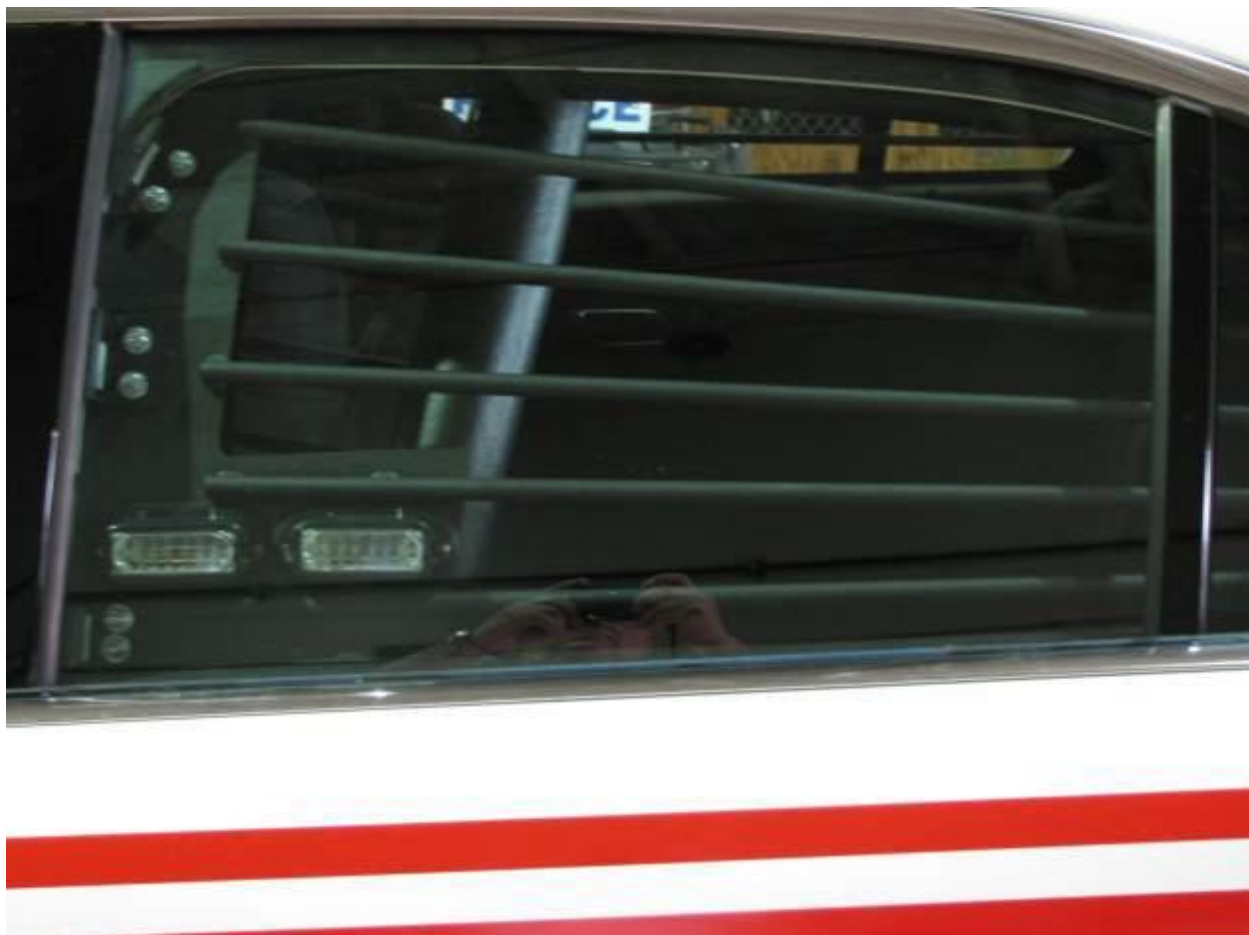
Figure 25 – Grillage de vitre et feux latéraux fixés à la vitre
