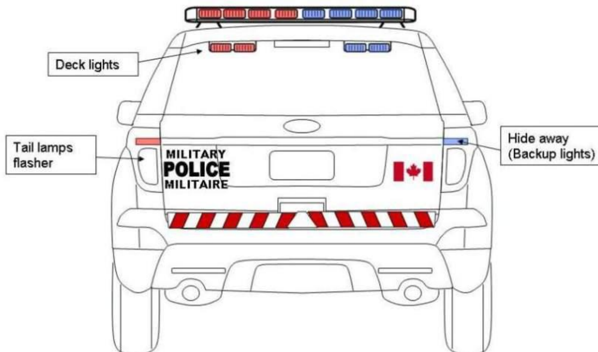
Figure 12 – Véhicule utilitaire Ford Interceptor identifié de la PM équipé d'une barre de feux d'urgence sur le toit (vue arrière)
