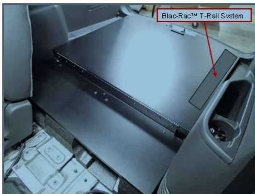
Figure 29 – Havis Products – Exemple d'installation de DRECP à plaque de chargement articulée
