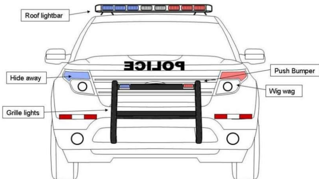
Figure 11 – Véhicule utilitaire Ford Interceptor identifié de la PM équipé d'une barre de feux d'urgence sur le toit (vue avant)
