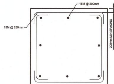
**2 REINFORCING DETAIL FOR SUMP PIT**
