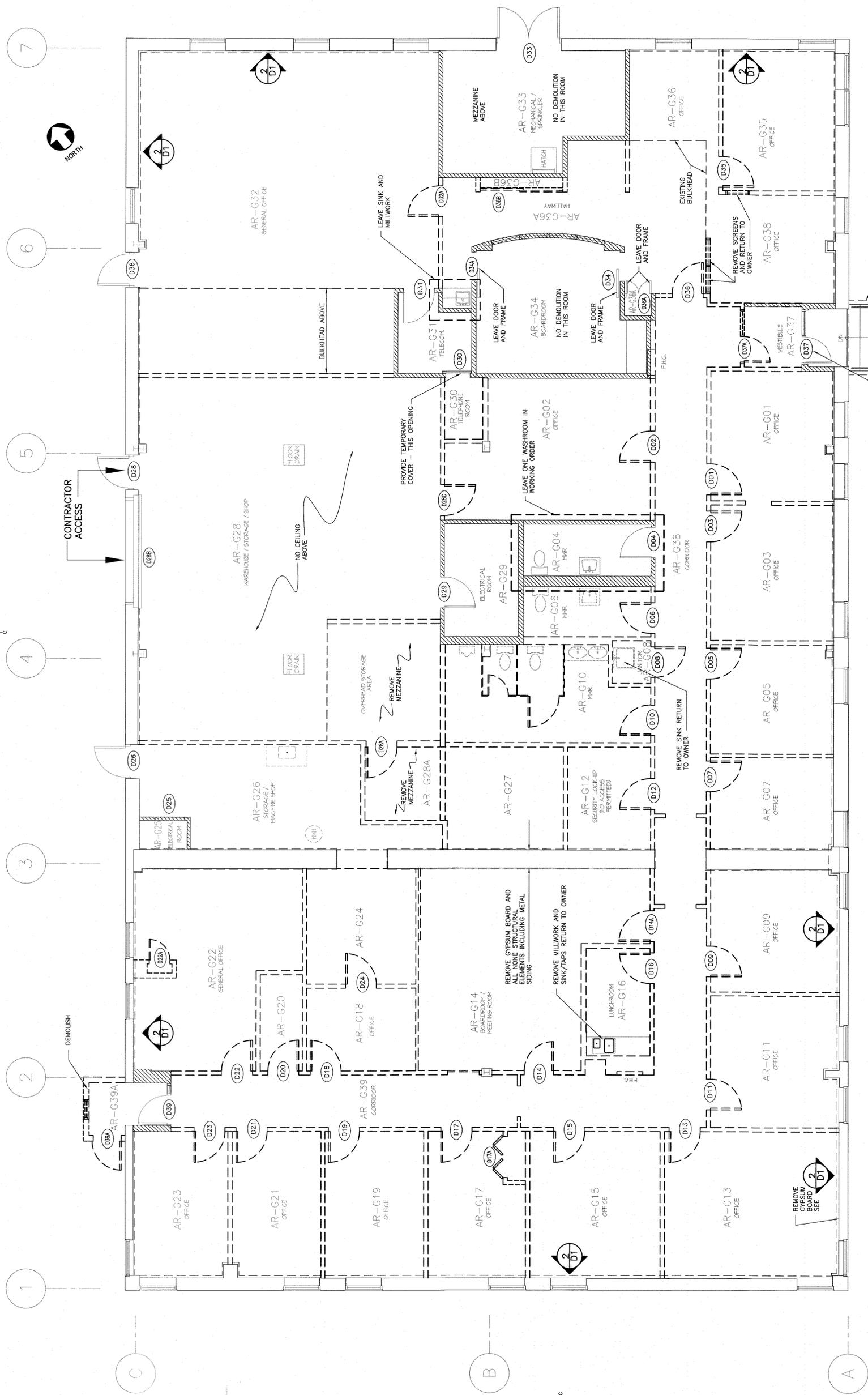
1 GROUND LEVEL FLOOR - DEMOLITION PLAN
