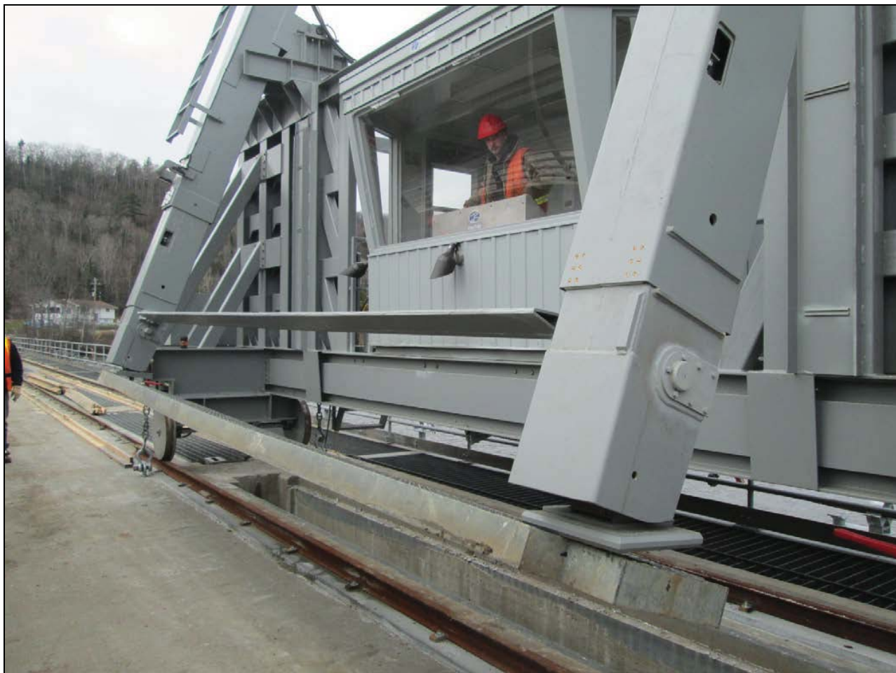
Figure 1 - Appareil de levage de poutrelles, côté aval, dont les flèches sont en train de soulever une grille de vanne. Observer l'absence de débord de toit au-dessus de la fenêtre.
