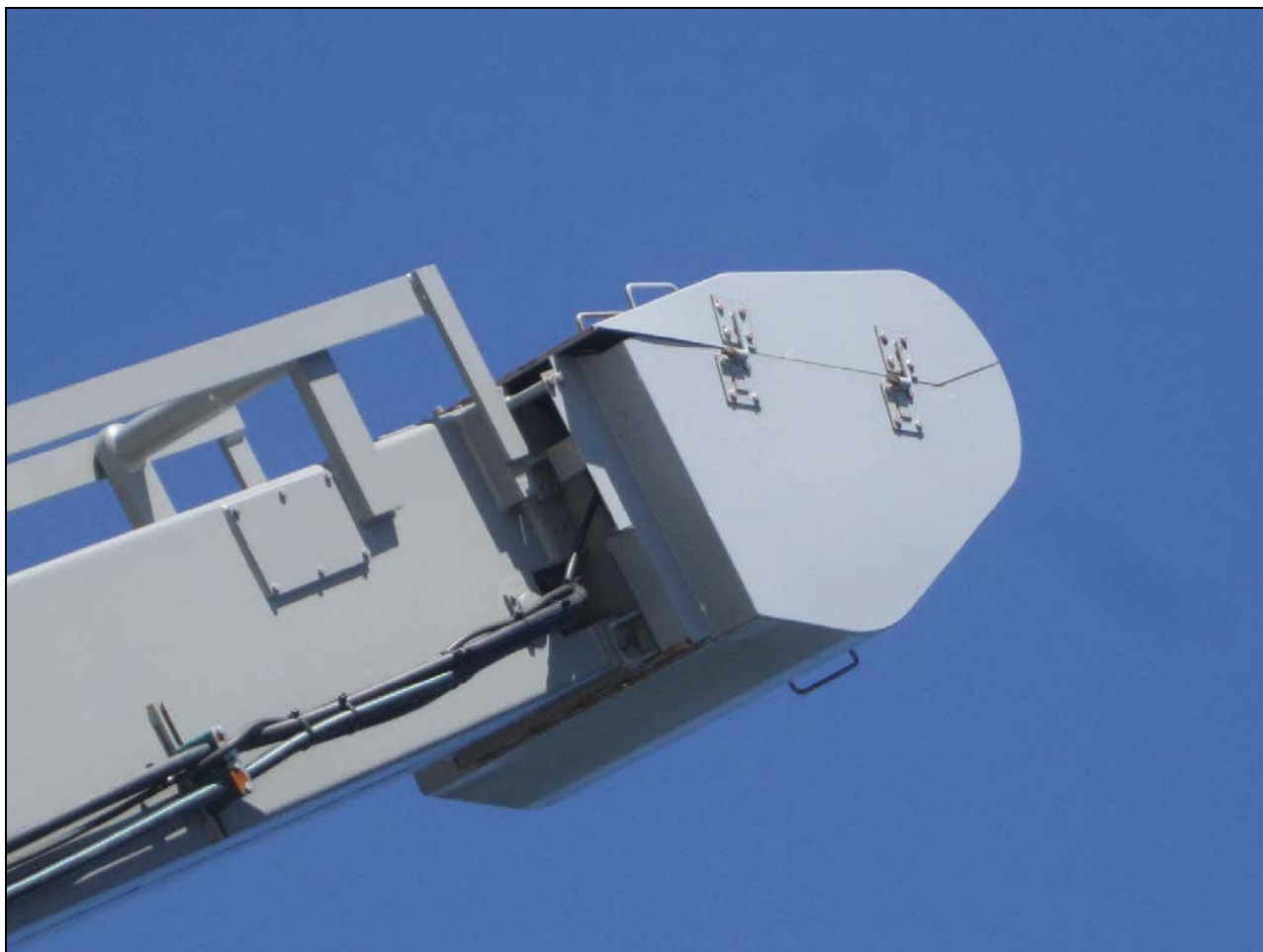
Figure 9 – Appareil de levage, détail du capot de dévidoir au sommet des flèches.
