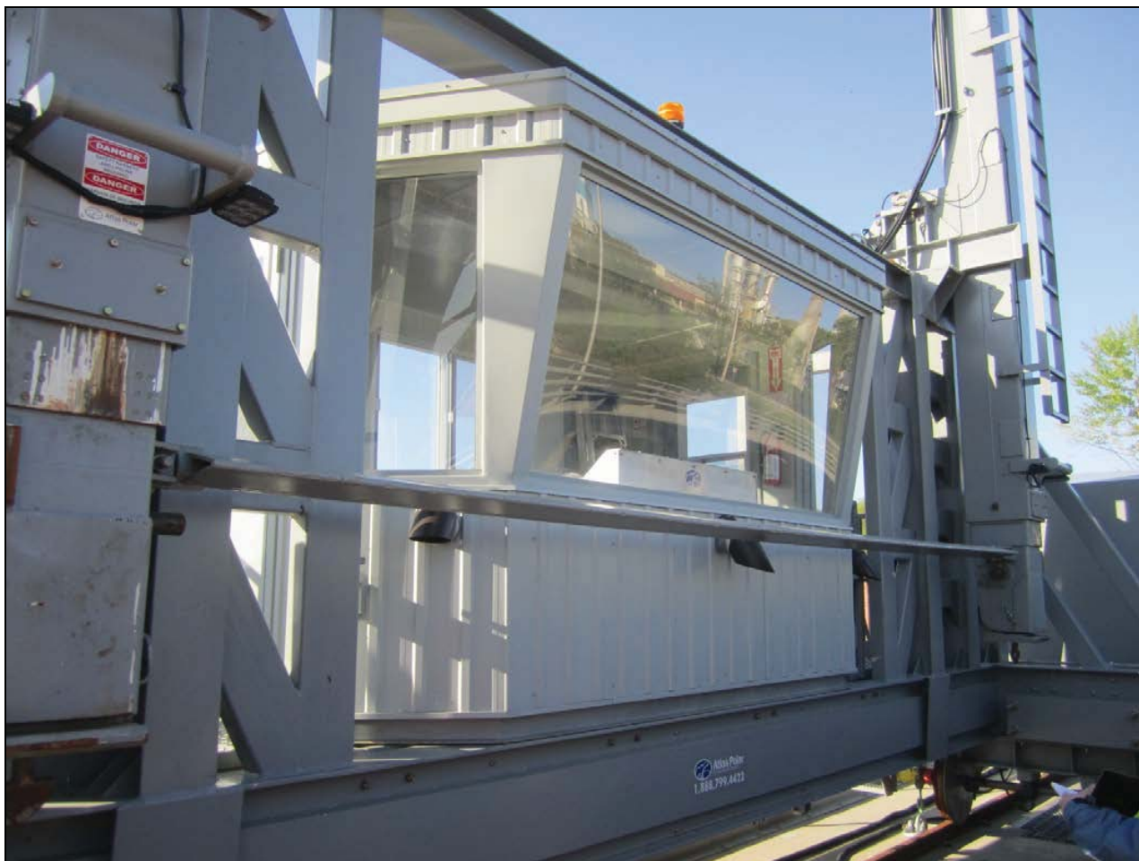
Figure 2 - Appareil de levage de poutrelles, côté aval, dont les flèches sont relevées et en position verticale. Observer l'absence de débord de toit pour protéger la fenêtre.
