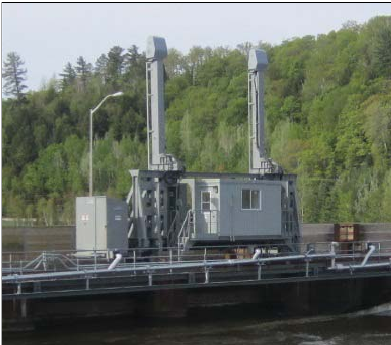
Figure 5 – Appareil levage de poutrelles du barrage de l'Ontario, côté amont.
