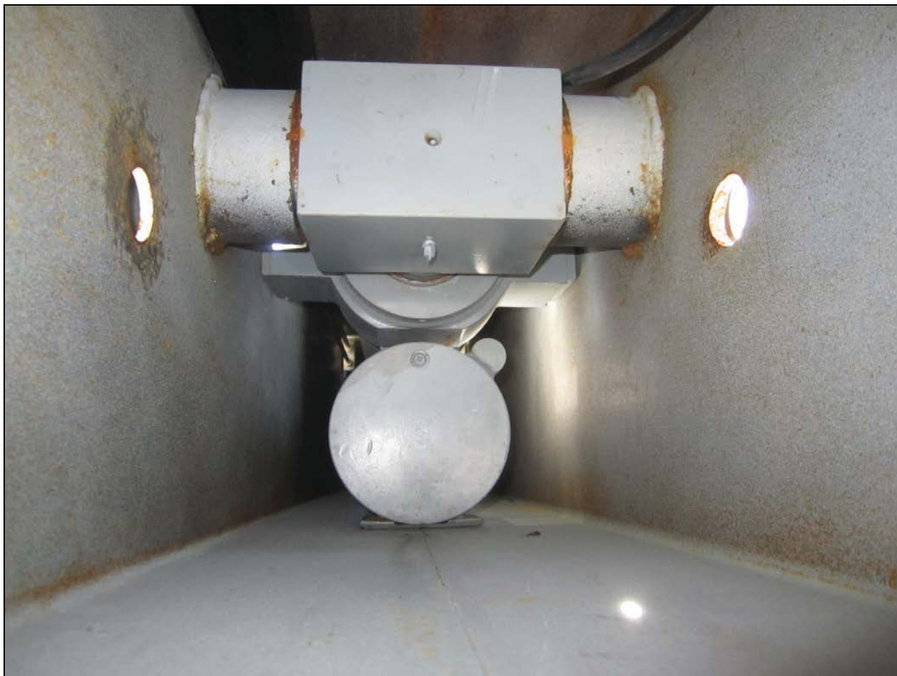
Figure 8 – Appareil de levage, vue à l'intérieur de la flèche juste au-dessus des crochets de harpon.
