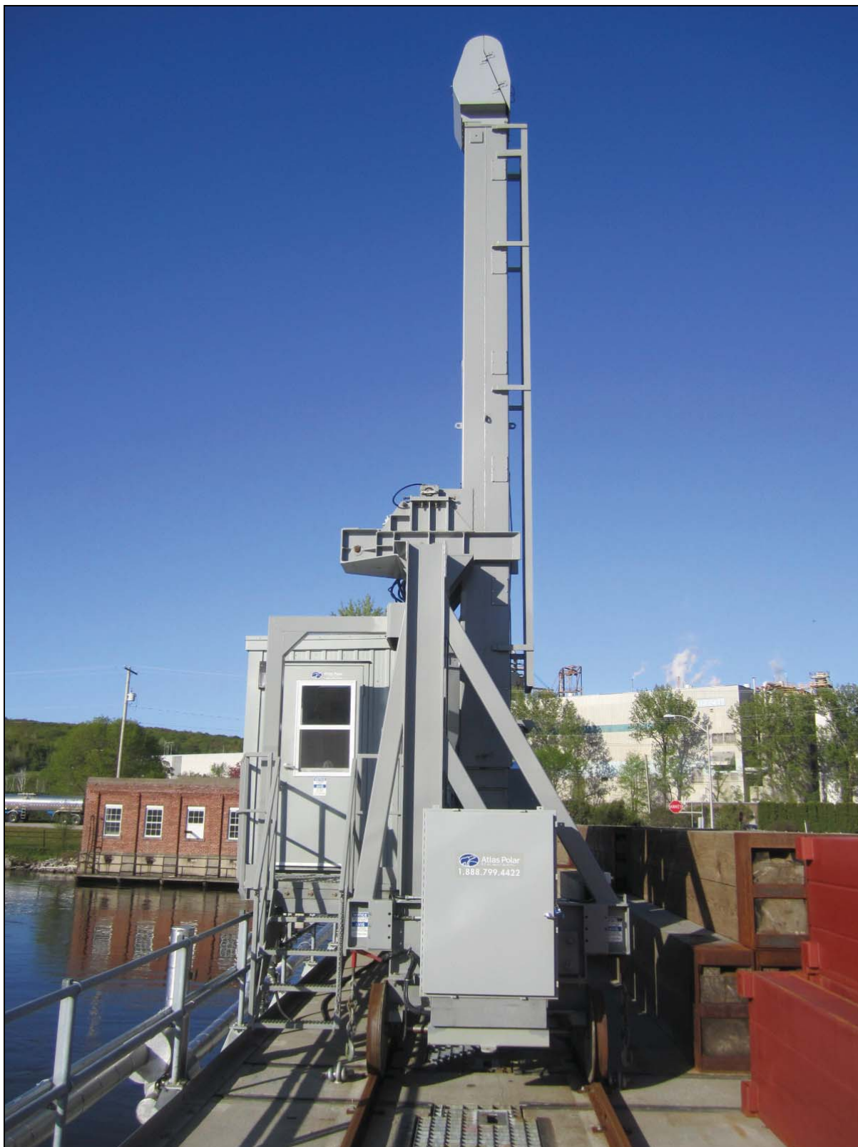
Figure 4 - Extrémité droite de l'appareil de levage de poutrelles du barrage de Québec,
