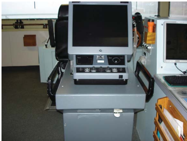
Photo 3 : Emplacement du radar en bande X pour le passage de câbles
