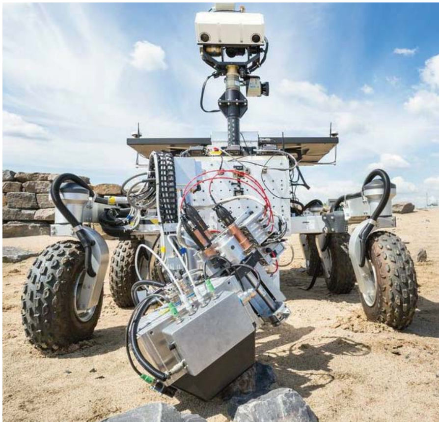
Figure 1 : Mini-carottier à l'extrémité d'un petit manipulateur sur le prototype du robot d'exploration martien
