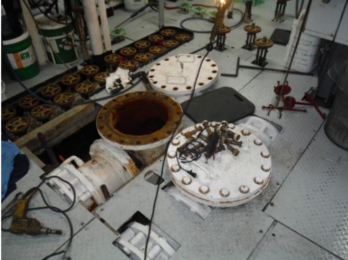
Figure 1 – Deux crépines, crépine avant avec couvercle retiré.
