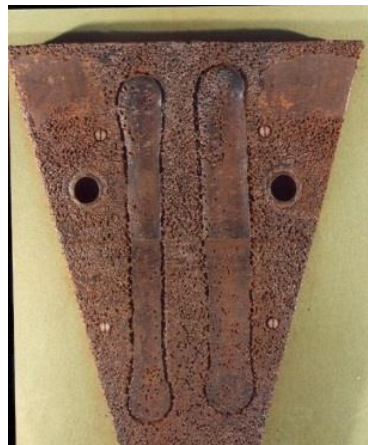
Figure 16 - Corrosion de la zone thermiquement affectée de la plaque de base
