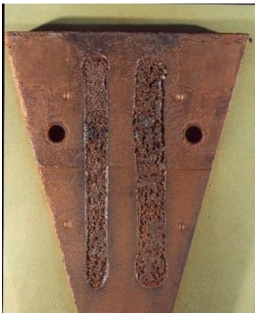
Figure 15 - Corrosion du métal de soudure
