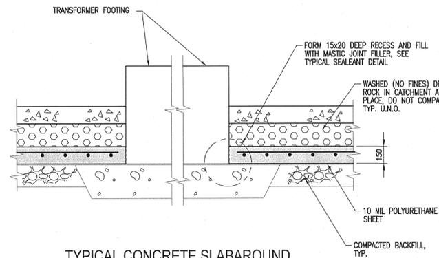
**TYPICAL CONCRETE SLAB AROUND TRANSFORMER FOOTING**
