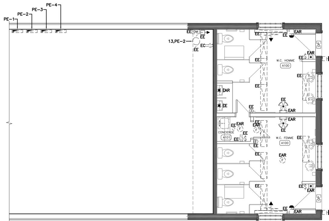
**DEMOLITION ÉCLAIRAGE ET SERVICES - PLAN PARTIEL REZ-DE-CHAUSSÉE**
