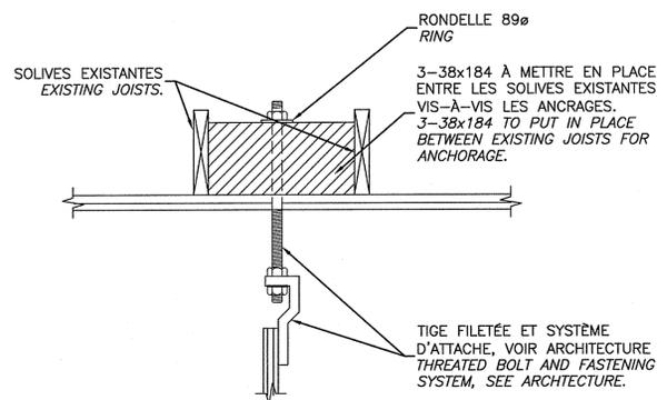
DÉTAIL D'ANCRAGE DE CLOISON
