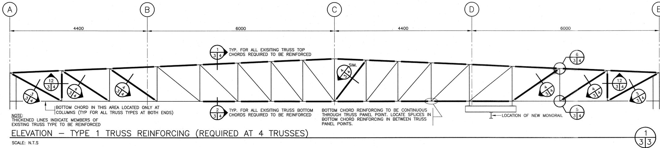
ELEVATION - TYPE 1 TRUSS REINFORCING (REQUIRED AT 4 TRUSSES)
